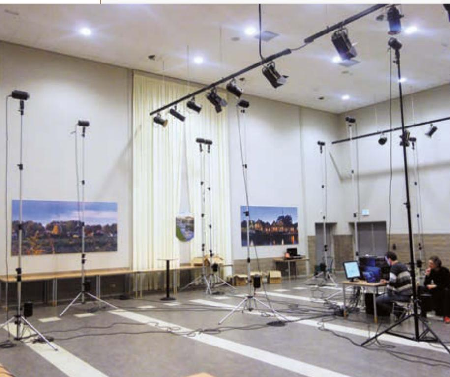
**Abb. 11:** Neben Mono- und Stereo-Quellmaterial sind auch kanalbasierte Setups möglich – Testaufbau eines 22.2-Systems (Foto: Bloomline Acoustics)
