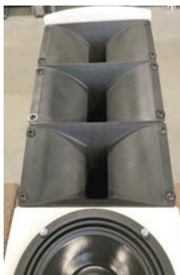
**Bild 3:** Die drei Hochtöner sind im festen Winkel zueinander montiert – das untere Horn ist nach unten geneigt und drei 1 Zoll Treiber sorgen für den Antrieb
