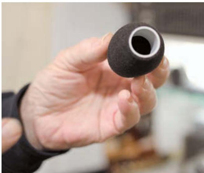
Bild 4: Der „neue“ Windschutz, hier als Prototyp des heutigen Serienprodukts B 5D – innen verhindert eine Plastikform direkten Kontakt mit der Kapsel. „Das D steht für Decca“, erklärt Jörg Wuttke. „Die Premiere der ‚Drei Tenöre‘ war der Stapellauf.“
