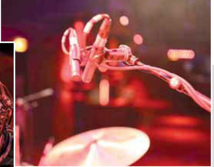
**Bild 4:** Als Overheads dienen Gifford zwei Neumann KM184 in X/Y-Anordnung
