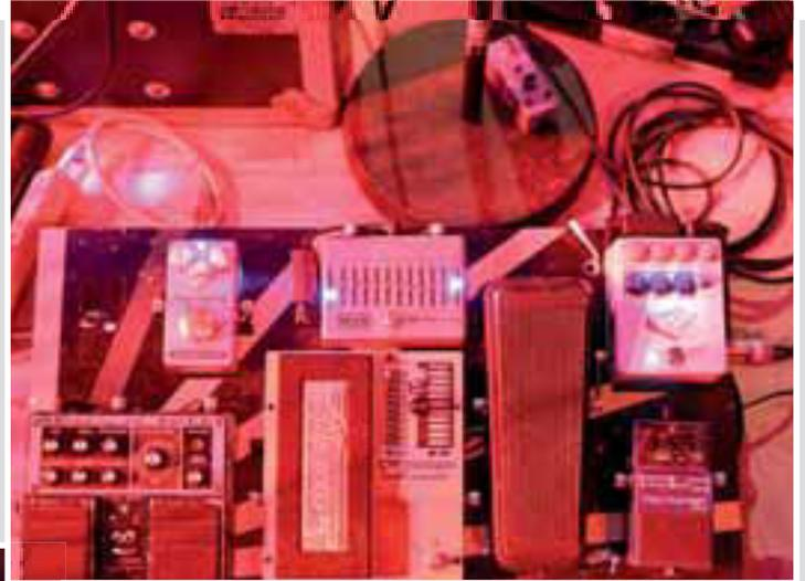
**Bild 10:** Auf Blooms Trompeten-Effektboard finden sich Whammy, Echo, Wah und Hall – dazu eine JHS Pedals „Colour Box“ (rechts oben), die Preamp, EQ und Verzerrung vereint sowie das Signal als DI-Box ans Pult abgibt
