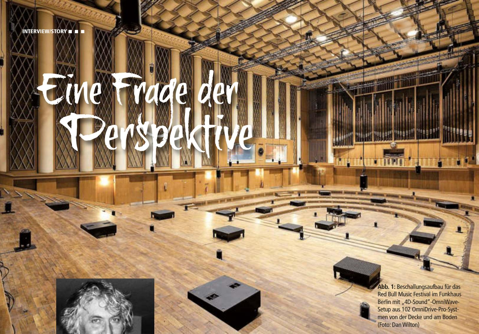
Abb. 1: Beschallungsaufbau für das Red Bull Music Festival im Funkhaus Berlin mit „4D-Sound“-OmniWave-Setup aus 102 OmniDrive-Pro-Systemen von der Decke und am Boden (Foto: Dan Wilton)
