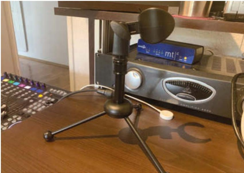
Schwachpunkte des Sets sind das Tischstativ sowie die Klemme, da sich Körperschall und andere Störgeräusche übertragen können
