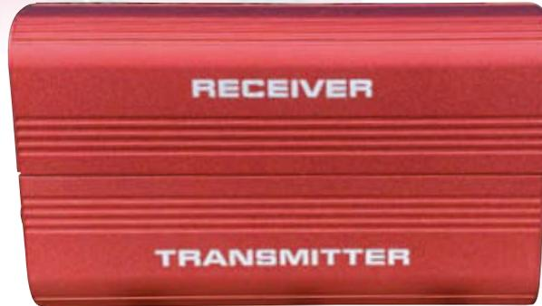
Empfänger und Sender des Multitesters SPT-3RT werden durch Magnete zusammengehalten
