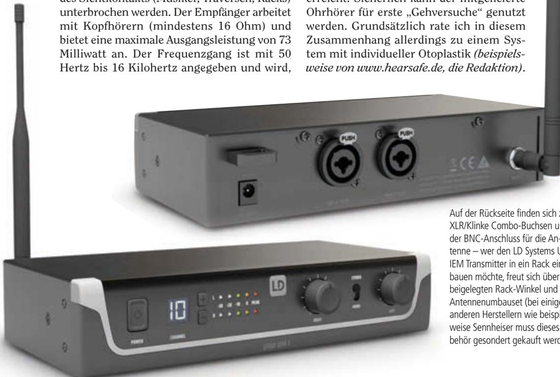
Auf der Rückseite finden sich zwei XLR/Klinke Combo-Buchsen und der BNC-Anschluss für die Antenne – wer den LD Systems U308 IEM Transmitter in ein Rack einbauen möchte, freut sich über die beigelegten Rack-Winkel und das Antennenumbauset (bei einigen anderen Herstellern wie beispielsweise Sennheiser muss dieses Zubehör gesondert gekauft werden)
