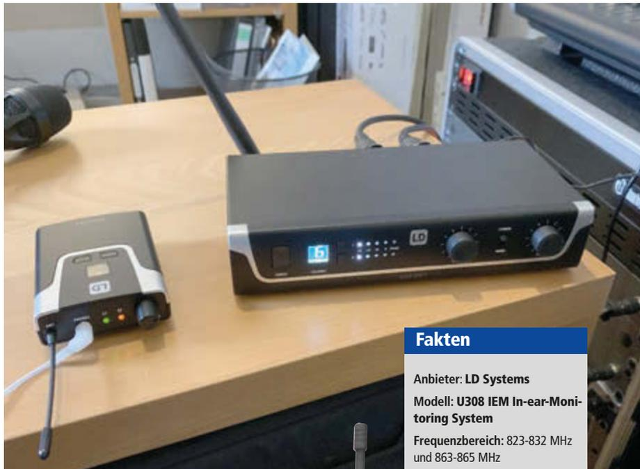
Das LD Systems 308 IEM besteht aus einem Sender, der mit den mitgelieferten Umbauteilen auch ins Rack eingebaut werden kann, sowie einem Bodypack-Empfänger
