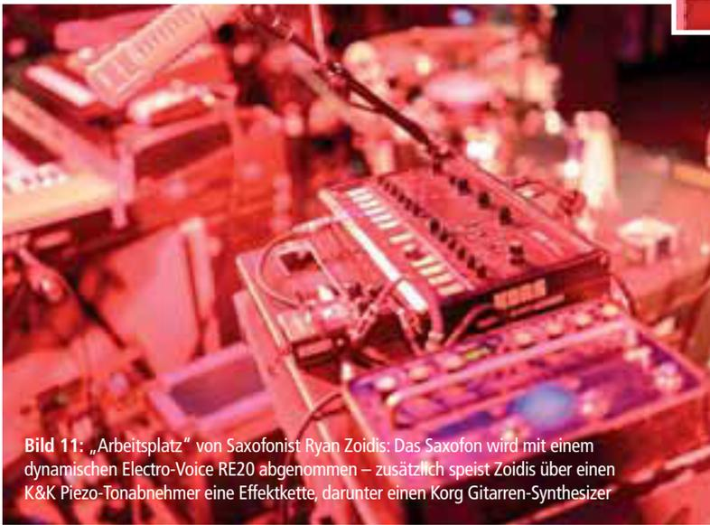
**Bild 11:** „Arbeitsplatz“ von Saxofonist Ryan Zoidis: Das Saxofon wird mit einem dynamischen Electro-Voice RE20 abgenommen – zusätzlich speist Zoidis über einen K&K Piezo-Tonabnehmer eine Effektkette, darunter einen Korg Gitarren-Synthesizer
