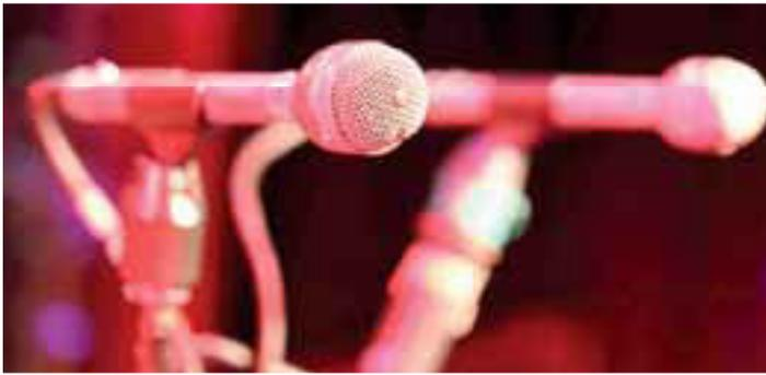
**Bild 9:** „Vintage“-Mikrofonierung: Zwei altherwürdige dynamische Electro-Voice RE1 Supernieren-Mikrofone von 1971 und 1973 – das linke Exemplar liefert ein unbearbeitetes Signal, das rechte speist die Effektkette von Trompeter Eric „Benny“ Bloom, bevor das Signal im Pult landet; Bloom wechselt je nach Passage zum gewünschten Mikrofon, Gifford zieht das Effektsignal nur bei den entsprechenden Solo-Einsätzen hoch, um Übersprechungen zu vermeiden
