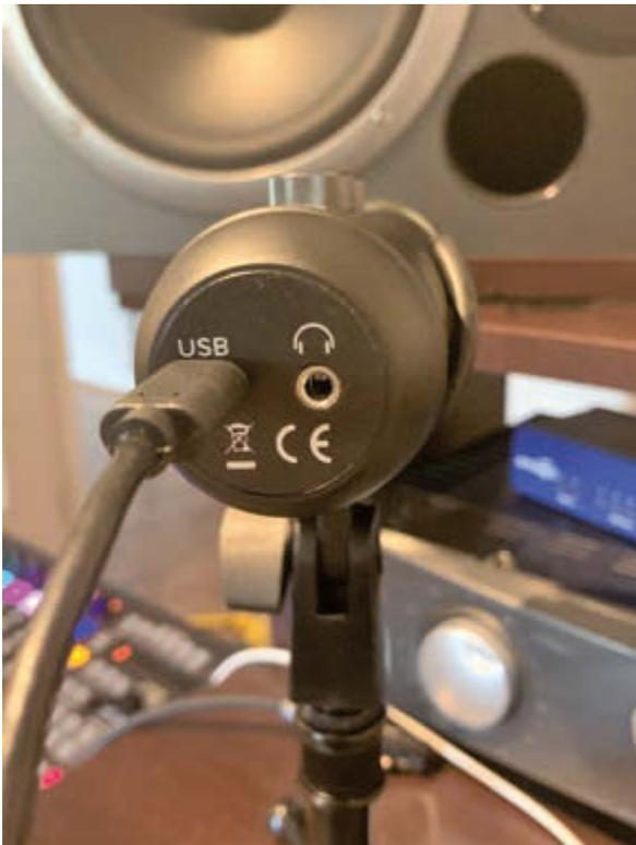
An der Unterseite befinden sich die USB-C-Buchse sowie der Miniklinken-Kopfhörerausgang
