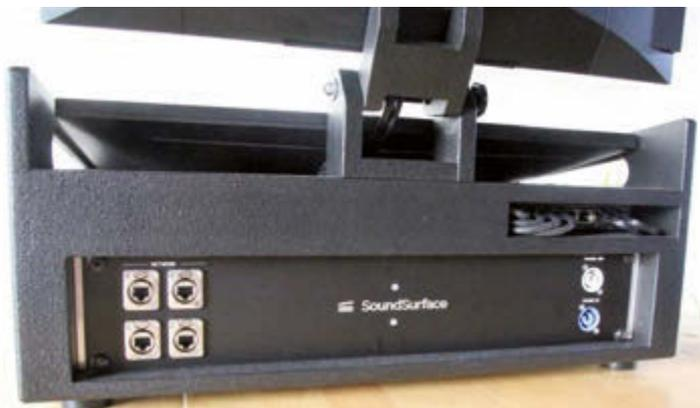
Die SoundSurface RP-Anschlussblende mit 4x etherCON-Buchsen und powerCON In/Out
