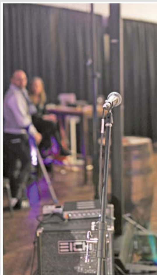
Bild 6: Das Shure SM58 vom Bassisten und Sänger Alvin Mills ist direkt vor einer der Bose Säulen positioniert – trotzdem ist ein Einsatz ohne Feedback möglich
