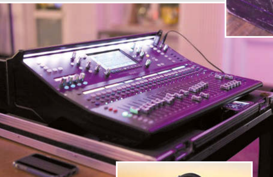
Bild 5: Als Pult nutzt Braun eine Allen & Heath SQ6-Konsole, bei der er normalerweise die Einzelkanäle per USB-Stick mitschneidet
