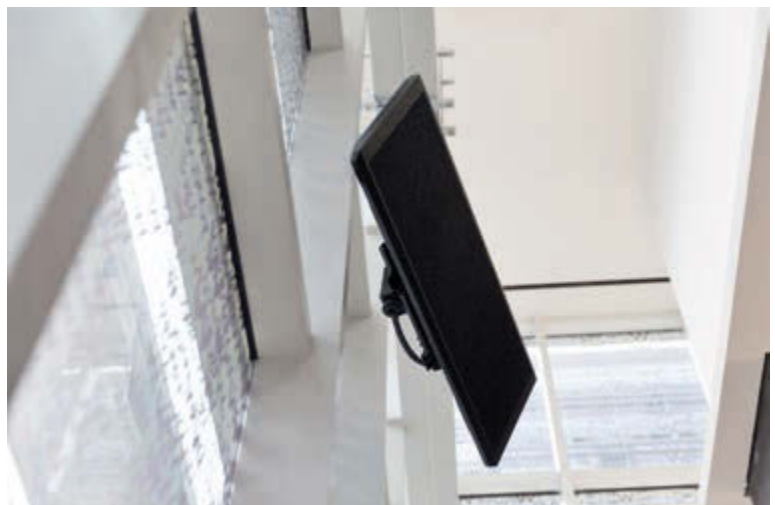
Bild 4: Installationsrahmen wie bei Flachbildschirmen ermöglichen flexible Aufhängung (Foto: Hyperactive)
