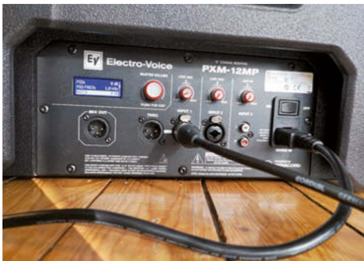
An die beiden Combo-Buchsen lassen sich auch direkt Kondensatormikrofone anschließen – die Phantomspannung (15 Volt) wird im Menü aktiviert
