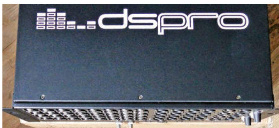
Um die BNC-Anschlüsse und die Potis der Kopfhörerverstärker zu schützen, sollte der Kandidat verzugsweise in ein Rack mit zurückgesetzten Rack-Schienen verbaut werden
