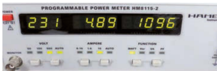
Bild 7: Der Wirkungsgrad von 72 Prozent bei 2x 400 Watt Leistungsabgabe errechnet sich aus der dem Netz entnommenen Leistung von 1.096 Watt
