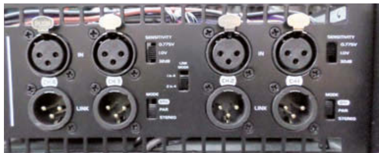
Bild 2: Mithilfe versenkter Schiebeschalter wird die Endstufe an die Bedürfnisse angepasst
