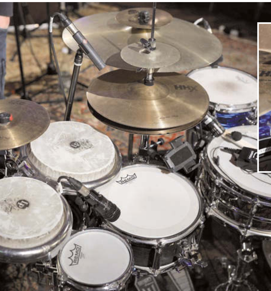
Bild 8: Der Hi-Hat dient ebenfalls ein KM184, ansonsten schätzt Niklas Braun Audix Mikrofone, etwa ein D2 an der Side-Snare, ein i5 an der Haupt-Snare, in der Bass Drum ein fest integriertes D6 und an den Toms ebenfalls ...
