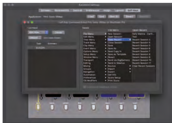
Die EuControl App sorgt für die Kommunikation des Avid S1 mit der DAW: Hier lassen sich auch einige Voreinstellungen für den Controller vornehmen, zum Beispiel die Belegung der Softbuttons
