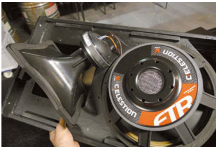
Treiber aus dem Hause Celestion – also dürfte die Ersatzteilversorgung auf längere Zeit sichergestellt sein; Hochtöner und Hochtonhorn (80 x 60 Grad, drehbar) sind in beiden Gehäuseausführungen identisch
