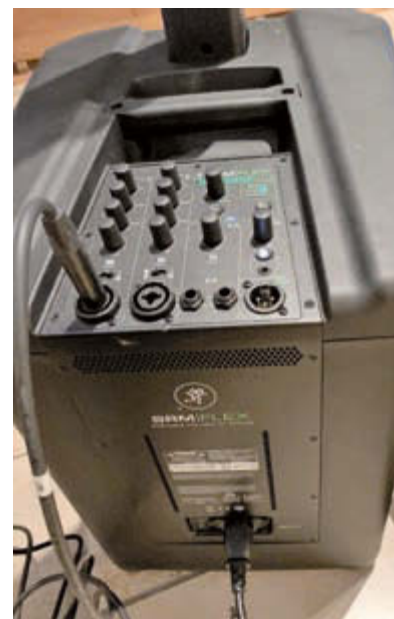
Alle Bedienelemente befinden sich auf der Oberseite des Subwoofers
