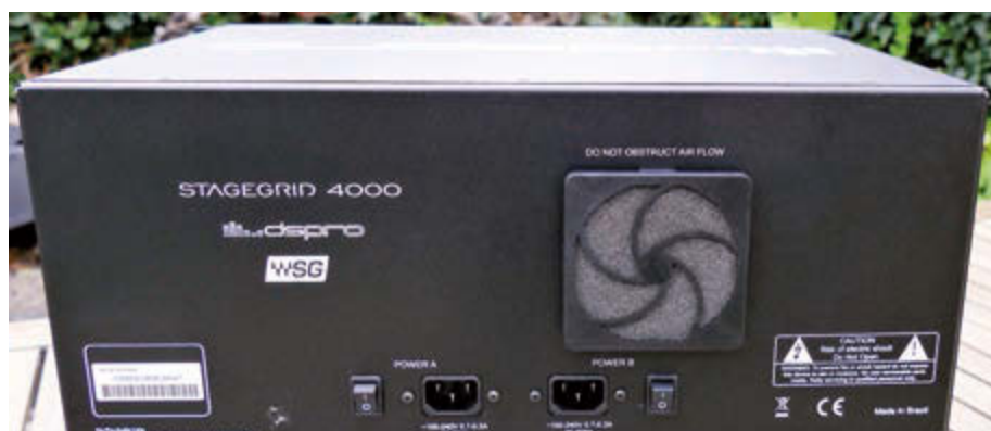
DSPRO spendierte der Stagebox zwei autarke Netzteile, was den professionellen Anspruch unterstreicht
