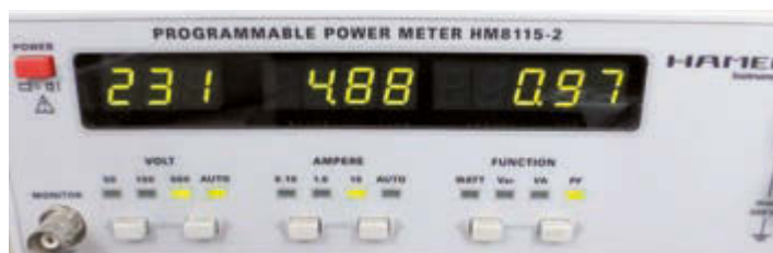
Bild 6: Bei Belastung der Endstufe mit 2x 400 Watt beträgt der Leistungsfaktor 0,97
