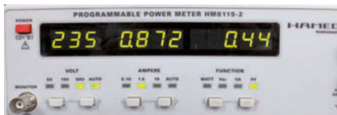
Bild 5: Im Ruhemodus nimmt die Endstufe 0,87 Ampere auf (92 Watt) und hat einen Leistungsfaktor von 0,44
