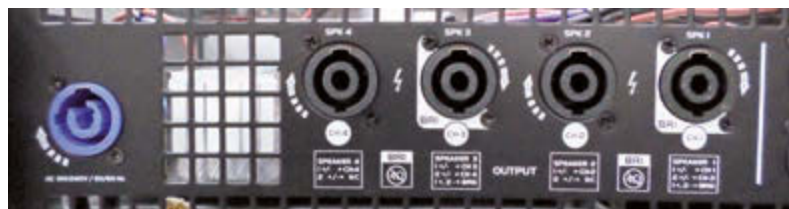
Bild 1: Klar und übersichtlich sind die Funktionen der Lautsprecherbuchsen beschrieben – die powerCON-Netzbuchse ist ein originales Neutrik Produkt, während die Lautsprecherausgänge aus Nachbauproduktion stammen
