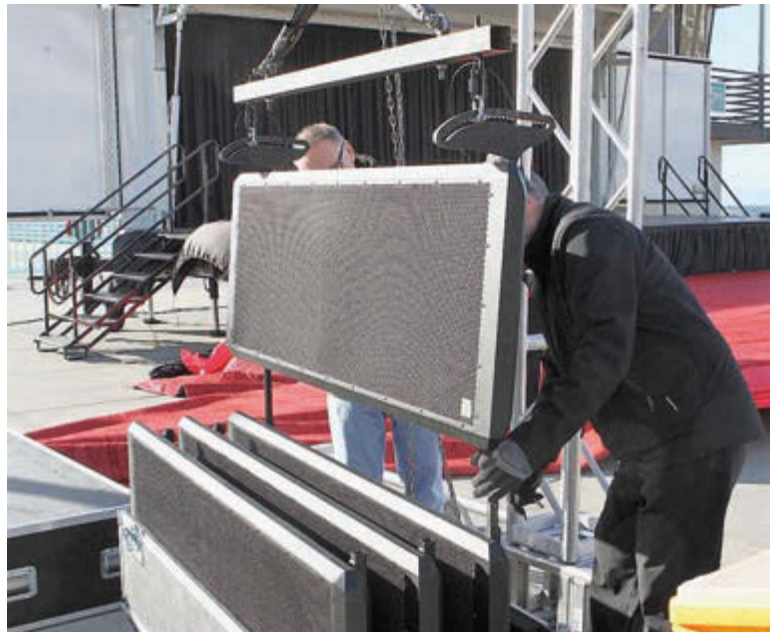
Bild 3: Laut Hersteller gestaltet sich das Rigging einfach – ein P11 Panel wiegt etwa 45 Kilogramm (Foto: Hyperactive)
