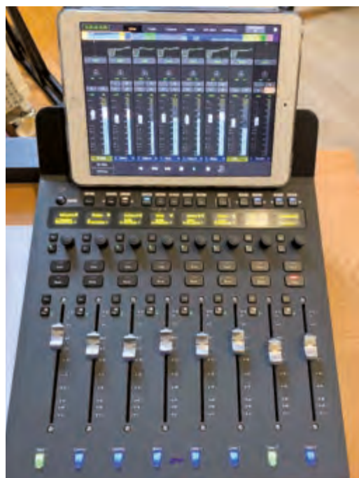
Der Avid S1 Studio Controller verfügt über acht berührungsempfindliche Motor-Fader, acht Push Encoder und jede Menge dedizierter Schalter – der Controller kann durch ein Tablet ergänzt werden, was aber keine Voraussetzung für dessen Funktionalität ist
