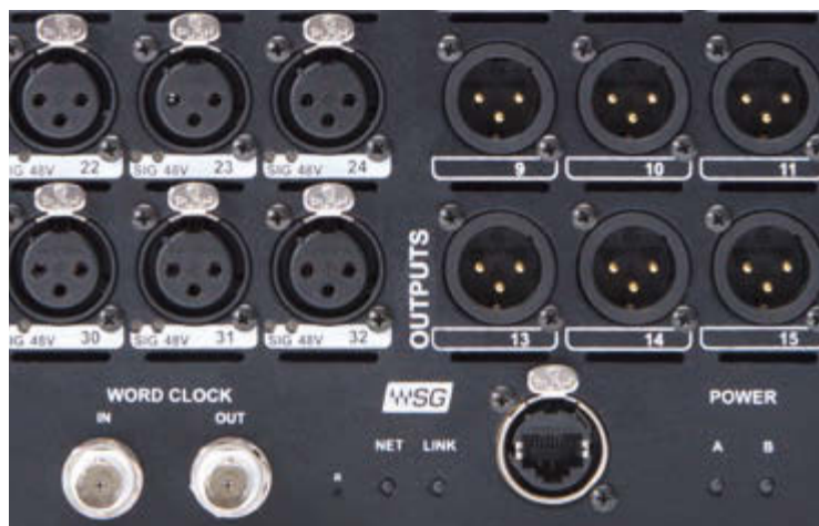
Die einsame EtherCon-Buchse erlaubt die Verbindung zum SoundGrid-Netzwerk
