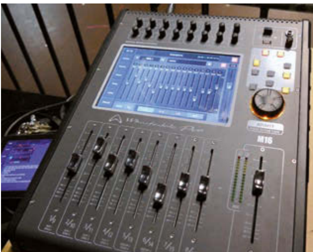
Die zwei frei patchbaren 31-Band-GEQs lassen sich über die 100 Millimeter Motorfader einstellen
