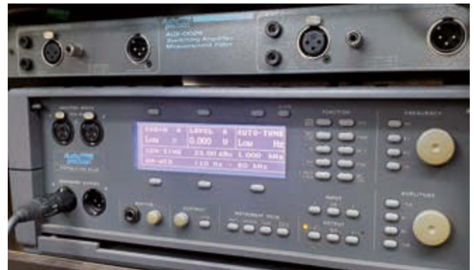
Bild 3: Der Audio Precision Portable One ist ein Multifunktion-Audio-Analyzer, der neben der Messung vieler Parameter auch die Klirrvverzerrungen filtern und separat ausgeben kann
