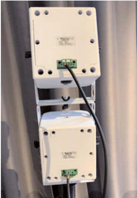
Neben einem Speakon-Anschluss an der Unterseite der Satelliten gibt es Schraubklemmen, um mehrere Satelliten miteinander zu verbinden
