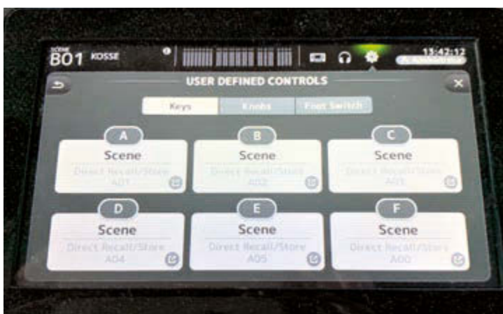
Die freie Belegung der „User Defined Controls“ schafft zusätzlichen Bedienkomfort und ermöglicht das Individualisieren des Pults
