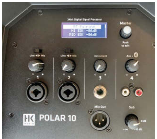
Das Bedien- und Anschlussfeld der HK Audio POLAR 10
