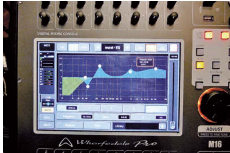
Der Kanal-EQ umfasst einen durchstimmbaren Low Cut und vier vollparametrische EQs: Shelving Filter sind nicht berücksichtigt
