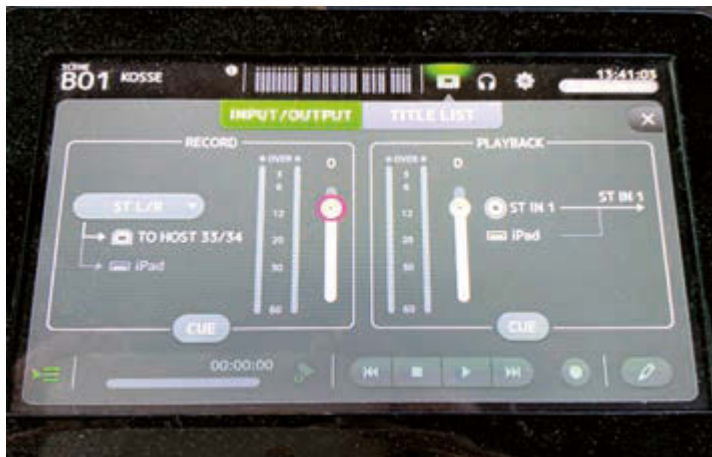
Der integrierte Stereo-Recorder/Player ermöglicht die Aufnahme des Master-Bus oder eines Aux-Busses
