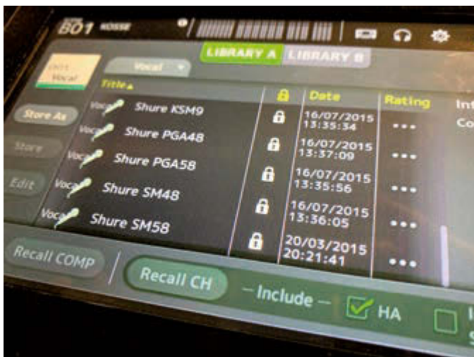
Eine Besonderheit sind die Presets für viele One-Touch-Funktionen, die in Zusammenarbeit mit Herstellern wie Audio Technica, Sennheiser und Shure erstellt wurden
