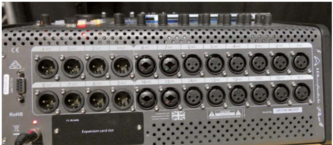
Die Rückseite des M16: Über Optionskarten lassen sich 2x In/2x Out Digitalausgänge im Dante-, AES- oder USB-Format ergänzen
