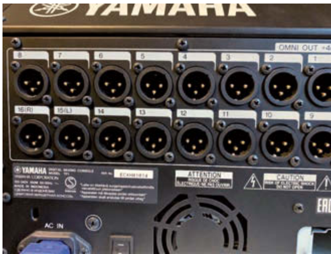
Rückseite: Footswitch für FX, Tap Tempo, USB to HOST für Computer Recording, Ethernet für Router, 16x Inputs (Combo XLR/Klinke), 16x Outputs (15/16 für Main), 2x Stereo RCA Inputs, Dante-Card-Erweiterung optional
