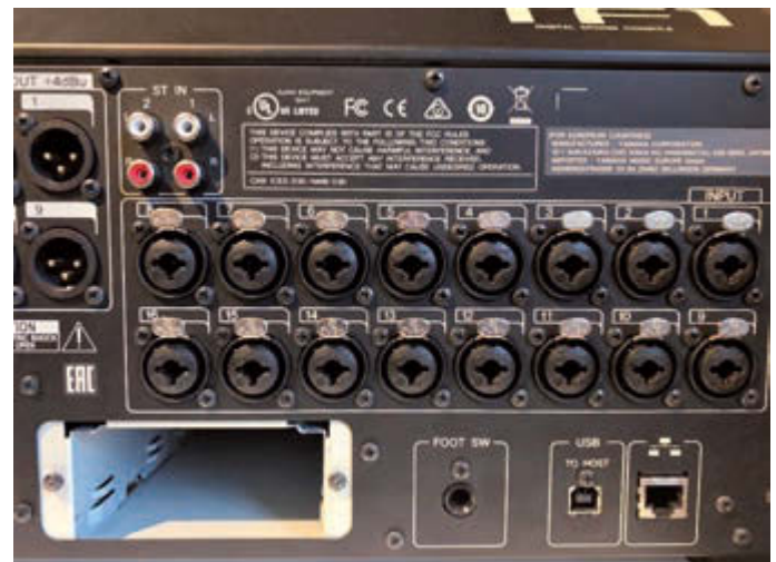
Rückseite: Footswitch für FX, Tap Tempo, USB to HOST für Computer Recording, Ethernet für Router, 16x Inputs (Combo XLR/Klinke), 16x Outputs (15/16 für Main), 2x Stereo RCA Inputs, Dante-Card-Erweiterung optional
