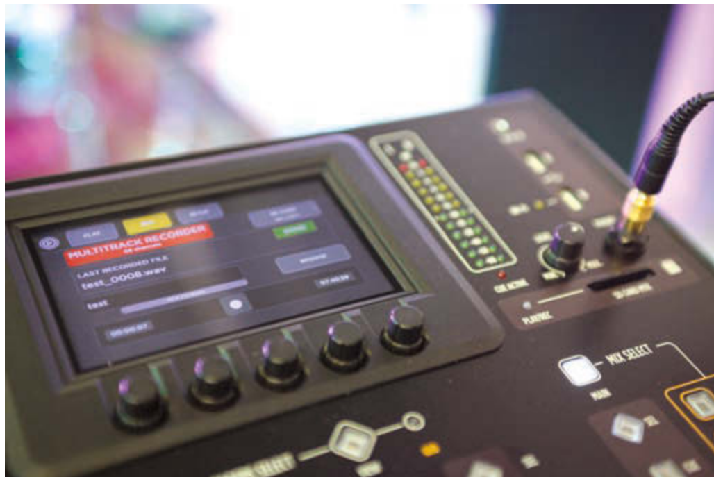
Recording geht ganz simpel – einfach via USB das 24-kanalige Audio-Interface nutzen oder direkt 20 Spuren auf eine SD-Karte aufnehmen
