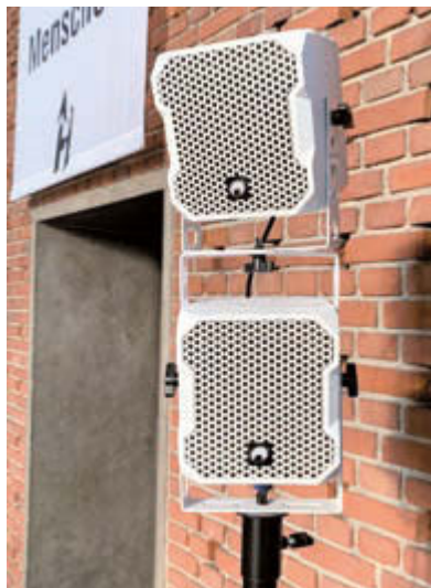
Im Testzeitraum wurde die Omnitronic BOB unter anderem als Delay Line bei einem großen Kirchenkonzert eingesetzt – insbesondere die Möglichkeit, zwei Tops übereinander zu montieren und verschieden auszurichten, sorgte für eine gute „Ausleuchtung“ des jeweiligen Zuhörerbereichs – als Mischpult diente die neu vorgestellte Behringer WING-Konsole
