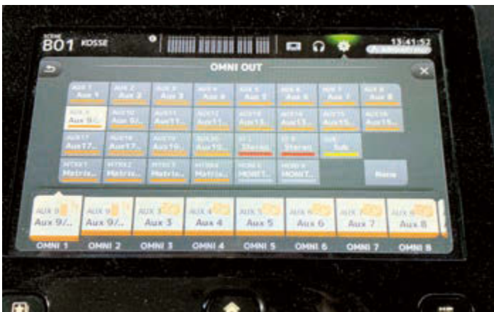
Die Omni Outs lassen sich flexibel konfigurieren, das gilt ebenso für das Bus Setup
