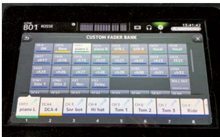
Mit der Custom Fader Bank sind eigene Kombinationen aller internen Eingänge und Busse auf die Fader zu legen
