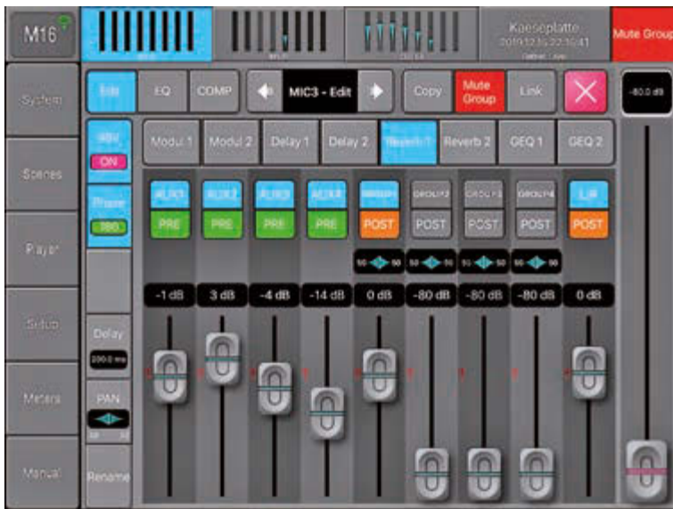
Der Mixer verfügt über insgesamt acht FX- und GEQ-Einheiten
