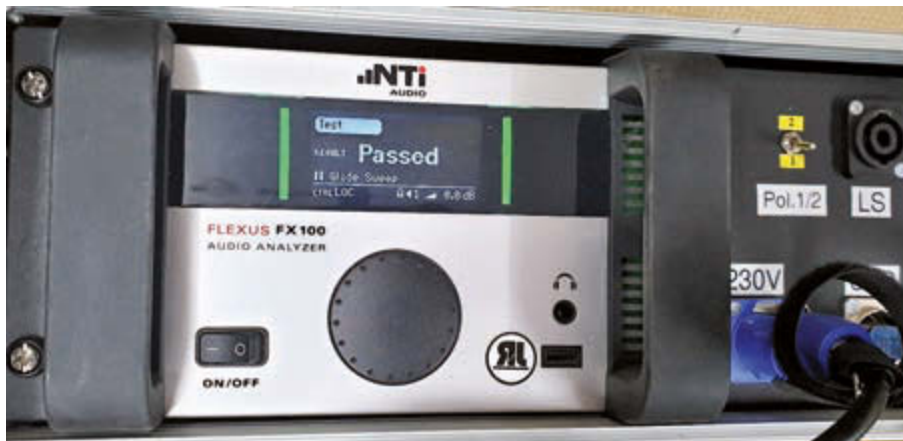
Bild 4: Mit dem NTI Audio FX-100 können geringste Verzerrungen gemessen sowie sämtliche Audiodaten im Messlabor erhoben werden
