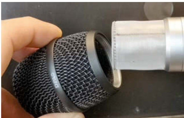
Der Korb und das Pop-Filter lassen sich beim DPA 2028 abschrauben und der darin liegende Windschutz zum Reinigen herausnehmen
