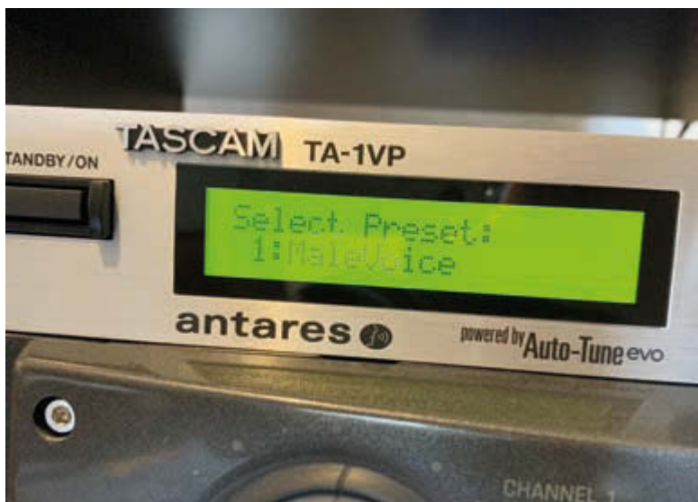
Jede Einstellung beginnt mit der Anwahl eines Presets – ein Default-Preset, mit dem das Gerät „genullt“ werden könnte, ist nicht vorgesehen
