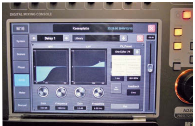
Sechs Effekteinheiten verfügen über High und Low Cut Filter sowie verschiedene Presets
