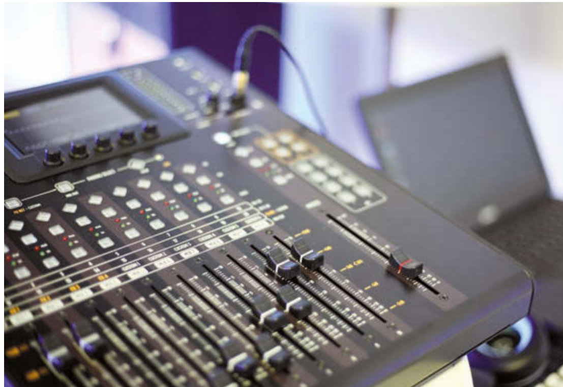
Eine Fader-Ebene beim M20X lässt sich zum Custom Layer machen – mit den wichtigsten Kanälen, das spart Zeit beim Mix
