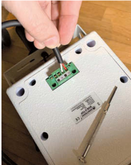
Neben einem Speakon-Anschluss an der Unterseite der Satelliten gibt es Schraubklemmen, um mehrere Satelliten miteinander zu verbinden
