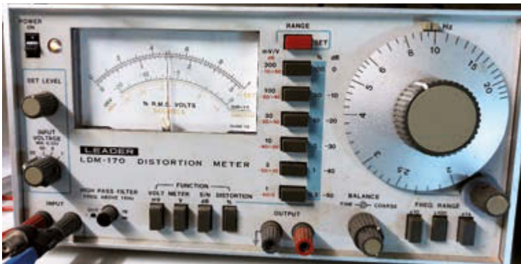
Bild 2: Mit solchen Klirrfaktormessbrücken begann die Zeit der professionellen Messung von Verzerrungsanteilen – der gemessene THD im Bild beträgt 0,15 Prozent
