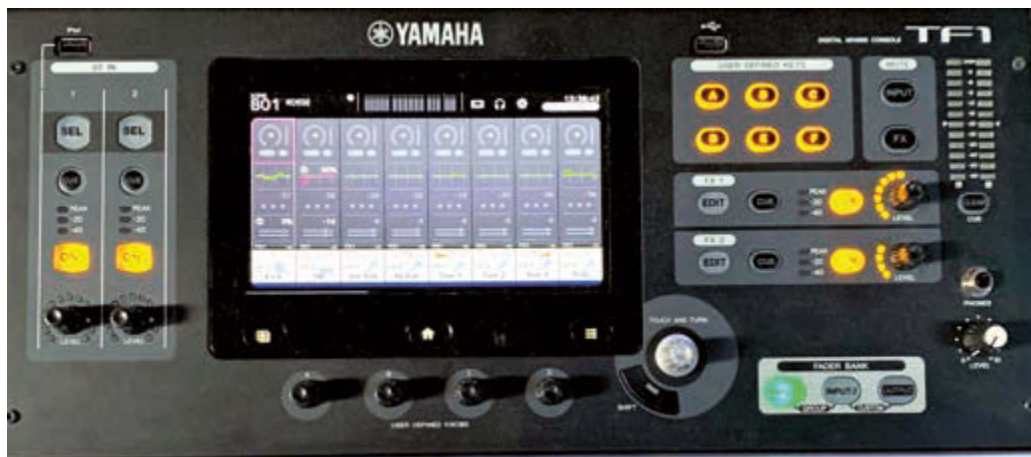
Das Yamaha TF-1 verfügt über ein gut zu bedienendes Touch Display und einen One Touch & Turn Knob – darüber lassen sich gängige Funktionen schnell abrufen
