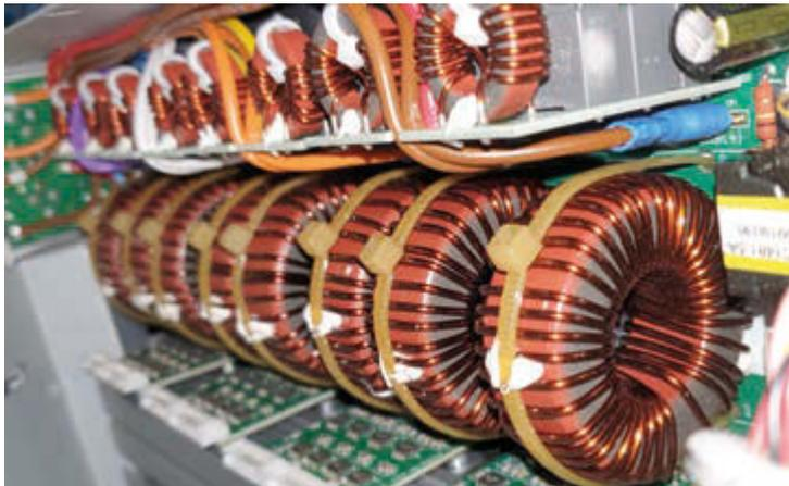
**Bild 15:** Mithilfe dieser Spulen und weiterer Kondensatoren werden die Tiefpässe gebildet, ohne die eine Klasse-D-Schaltung zu hohe Modulationsignale aussenden würde – die LC-Tiefpässe demodulieren die PWM-Signale und machen das Audiosignal hörbar
