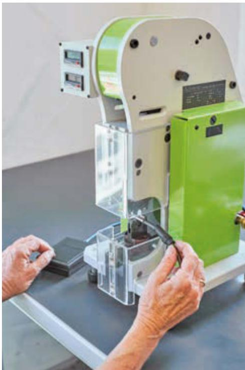
Gasfreie Produktion eines Tricone-Klinkenkabels mittels Crimpautomat
