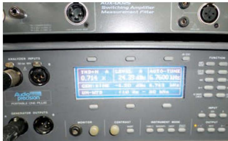
**Bild 9:** Um letzte Zweifel auszuräumen, überprüfe ich erneut, diesmal mit einem Audio Precision Portable One, abermals sind die THD-Verzerrungen mit angezeigten 0,714 Prozent deutlich
