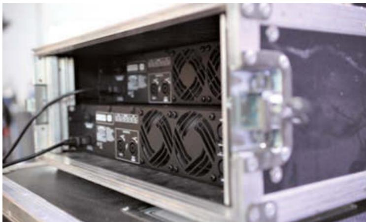
Bis auf die Einbautiefe sind beide Modelle praktisch baugleich – ein Standard-Rack mit 40 Zentimeter Einbautiefe reicht aus, um die MX-Amps zu transportieren
