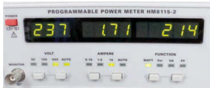
**Bild 2:** Der Hameg HM8115 dokumentiert die Leistungsaufnahme der angeschlossenen Endstufe mit 214 Watt im Leerlauf
