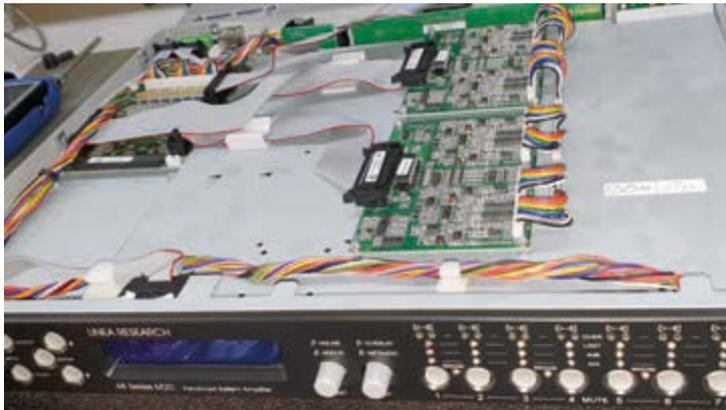
**Bild 16:** Nach Abnahme des Gehäusedeckels wird der Blick auf die eingebauten Digital-Controller möglich
