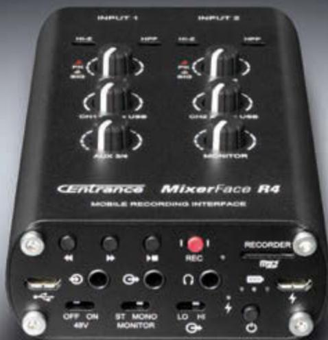
Centrance MixerFace R4R: ein zweikanaliger High-End-Preamp, ein kompaktes 4x2 Mischpult, ein MicroSD-Card-Recorder, ein USB-Audio-Interface mit feinsten Digitalwandlern, ein kräftiger HiFi-Kopfhörerverstärker. Ein ultrakompaktes und dank des eingebauten Akkus überall nutzbares Gerät – für Tonschaffende mit höchsten Ansprüchen.
