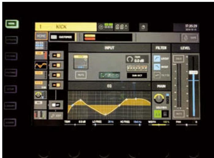
Der Kanal-EQ verfügt über sechs Bänder mit zusätzlichen High- und Low-Cut-Filtern
