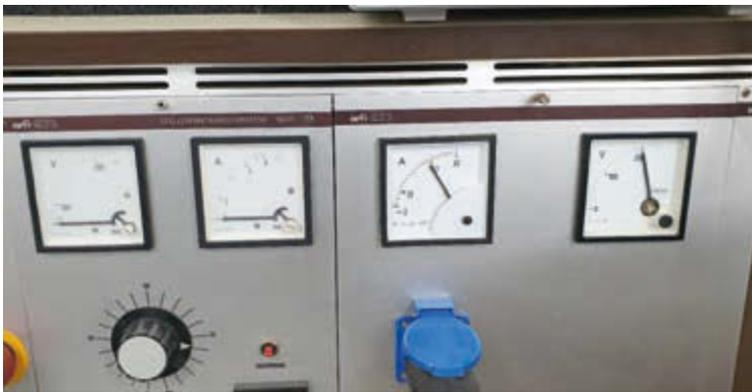
**Bild 1:** Im tools-Labor verwende ich eine 230 Volt Spannungsversorgung mit 32 Ampere Absicherung – das Foto zeigt die Stromaufnahme der Linea Research 48M20 innerhalb der Testdurchgänge bei Impulsmessungen
