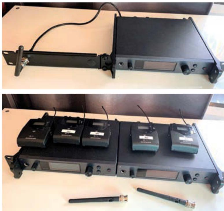
Für den Einbau in ein Rack liegt das Rackmount-Kit bei; man benötigt zusätzlich das AM2 Kabelset (49 Euro) für den Umbau der Antennen – leider ist es nur beim Umbau eines einzelnen Senders möglich, die Antennen vorne anzubringen (Sennheiser empfiehlt den hauseigenen Antennen-Combiner, der allerdings recht teuer angeboten wird)
