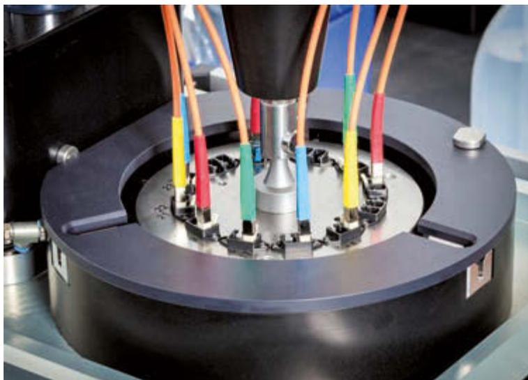
Multi-Poliervorrichtung aus der Fiberoptik-Systemfertigung
