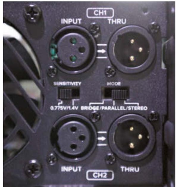
Zwei XLR-Duos für die Signale und zwei Schiebeschalter zur Anpassung der Eingangsempfindlichkeit und der Betriebsmodi – den Probanden fehlt eine Verriegelungsmöglichkeit für ankommende XLR-Signale
