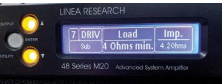
**Bild 19:** Vor der Messung muss die korrekte Ausgangsimpedanz eingestellt werden – zusätzlich wird die tatsächliche Lastimpedanz gemessen und angezeigt
