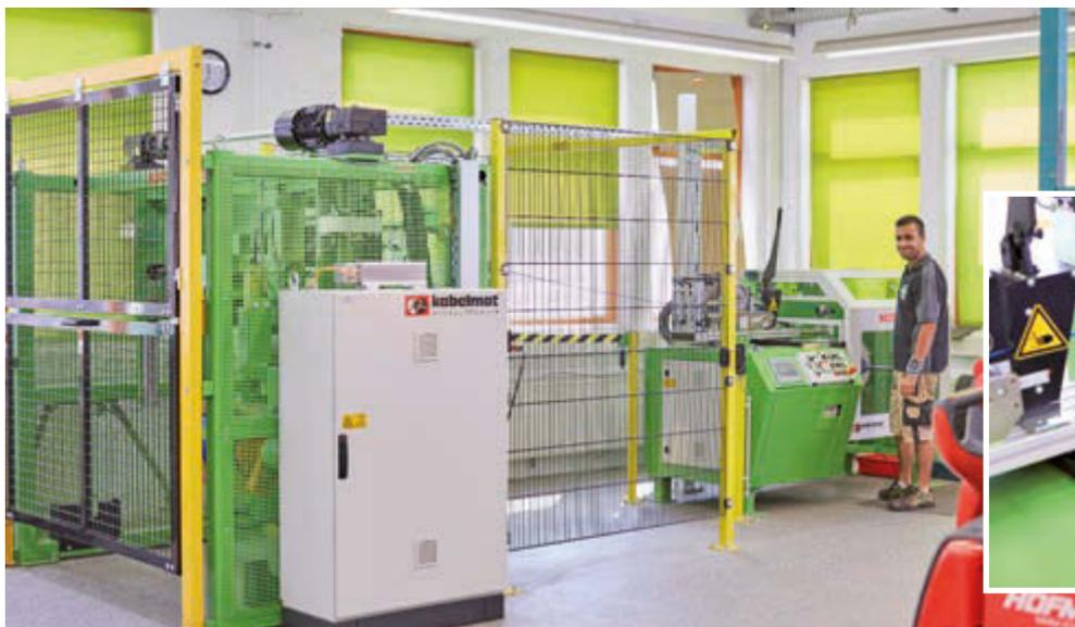
Der Kabelwickelautomat mit automatischer Seitenverlegung ...
