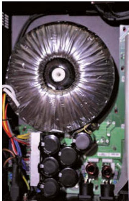
Ein konventionelles Netzteil mit Ringkerntrafo sorgt bei den MX-Endstufen für die Betriebsspannung
