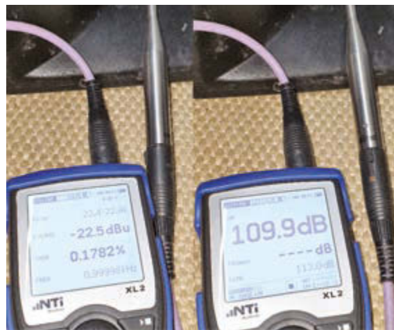
Bild 11: Abermals beträgt der Schallpegel 104 Dezibel (SPL), jedoch erzeugt das MIPRO MM-100 dabei eine Ausgangsspannung von -22,5 dBu – der dazu nicht passend kalibrierte NTi XL-2 zeigt fälschlicherweise einen Schallpegel von 109,9 Dezibel (SPL) an
