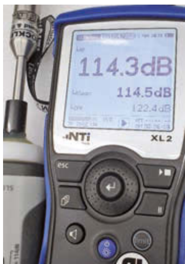
Bild 4: Der NtI Audio XL-2 Analyzer ist kalibriert – der Referenzschalldruck aus dem Kalibrator beträgt 114 Dezibel: Je nach verwendetem Mikrofon stehen unterschiedliche Ausgangsspannungen bereit, auf die ein Analyzer eingestellt werden muss
