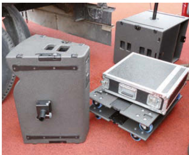
An der A15 Wide ist ein A-MOUNT Stativadapter angeschraubt – die Rollbretter der KS21 sind stapelbar
