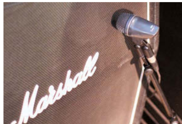
Bild 9: No-Name-Mikrofon vom Club an Aireys 4x 12 Zoll Box seines Marshall Amps für die Hammond-Orgel, dazu Hodgkinson: „Bei dem Signal brauche ich nichts Hochwertiges, da der Amp einen Fuzz-Sound anliefern. Ein Mikrofon, das lediglich den Bereich zwischen 400 Hertz bis 2 Kilohertz abbildet, wäre vollkommen ausreichend.“
