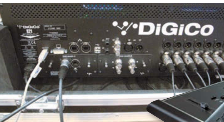
USB-Port des UB MADI Interface, Netzwerkschlus und DMI Slots
