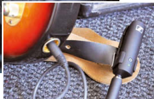
Mit dem Belt Clip und dem Extension-Kabel (rechts) lässt sich der Sender sehr flexibel am Gurt des jeweiligen Instruments (Gitarre, Bass) montieren
