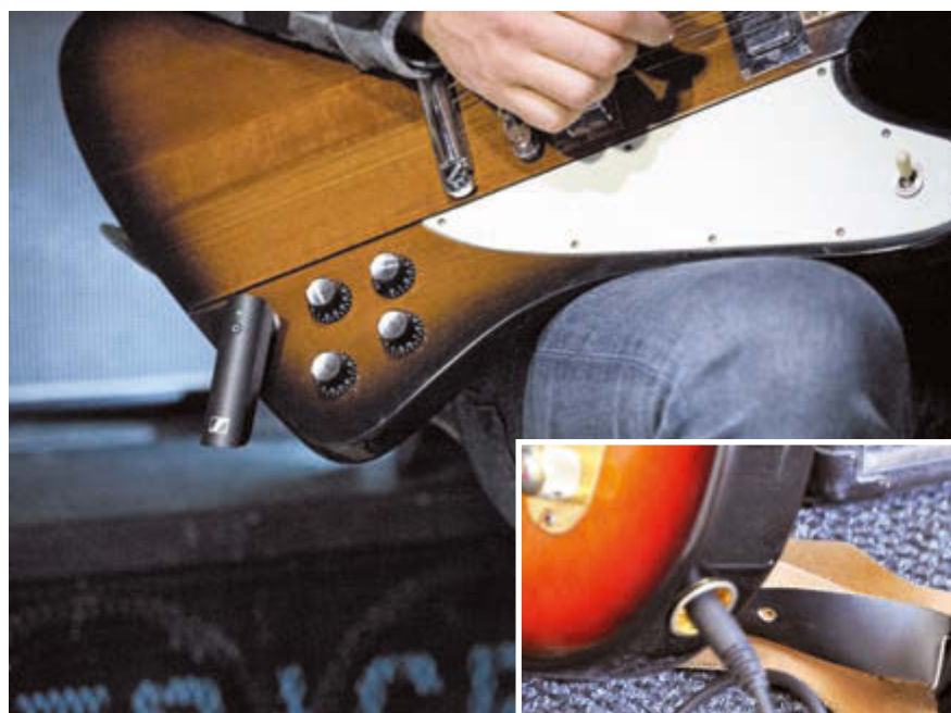
Mit dem Belt Clip und dem Extension-Kabel (rechts) lässt sich der Sender sehr flexibel am Gurt des jeweiligen Instruments (Gitarre, Bass) montieren
