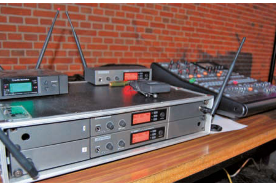
Der erste Test der LD Systems MEI1000 G2 IEMs – der günstige Preis und die Möglichkeit, mit einem Sender und zwei Empfängern zwei Musiker mit individuellen Mixes zu versorgen, macht das Produkt für IEM-Einsteiger interessant
