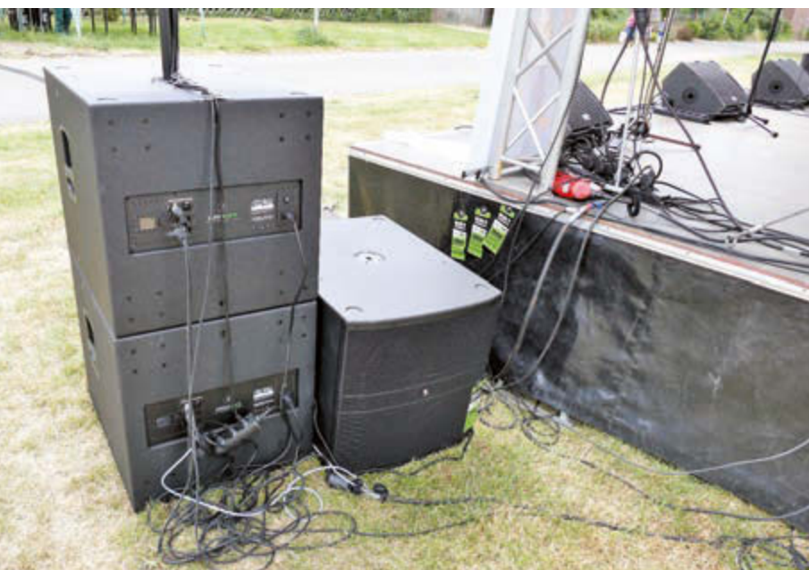
Da die Subwoofer nur mit einem Kaltgerätekabel betrieben werden können, die Topteile aber PowerCON bevorzugen, ist Kabelsalat unvermeidlich
