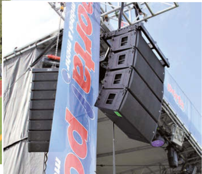
Bild 4: Vier al12-Module (rechts) dienen als Hauptbeschallung
