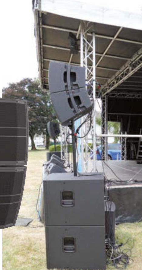
Bis zu zwei DRM12A Topteile können auf einer Distanzstange „aufsitzen“
