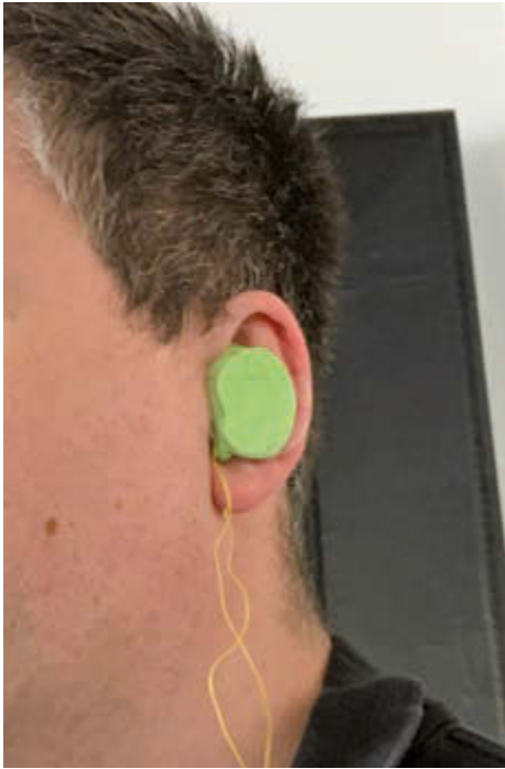
Neben der Technik machen beim In-ear-Monitoring gerade die verwendeten Ohrhörer einen Großteil des Klangs und der Zufriedenheit aus – seit Anfang Mai 2019 sorgen individuell angepasste Otoplastiken, angefertigt bei Hear-safe in Köln, für eine ultimative Verbesserung
