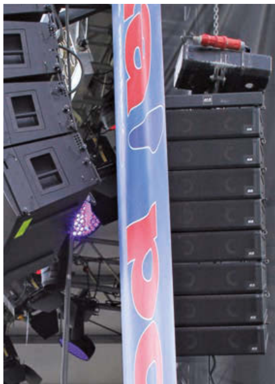
Bild 9: Ein Outfill aus acht kompakten al-4 Modulen, das seitlich am Sponsoren-Banner vorbeischallt, übernimmt pro Array-Seite die HF-Beschallung der Seitenbereiche, ...
