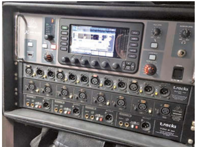
Das XR18 wurde durch ein X32 Rack ersetzt – weitere Splitter und eine 4-fach DI-Box ergänzen das System und legen damit auch Anschlüsse nach vorne
