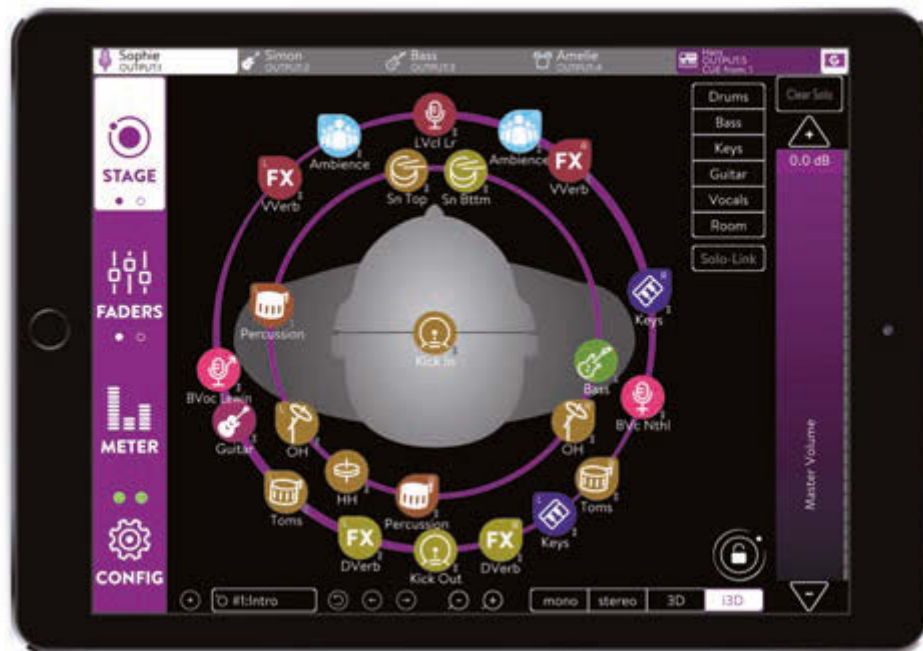
Zentrum der KLANG:app ist der virtuelle Kopf des Musikers, um den herum die einzelnen Instrumente in 3D angeordnet werden können: Es entsteht eine realistische Klangwelt als Grundlage für Monitor-Mixe
