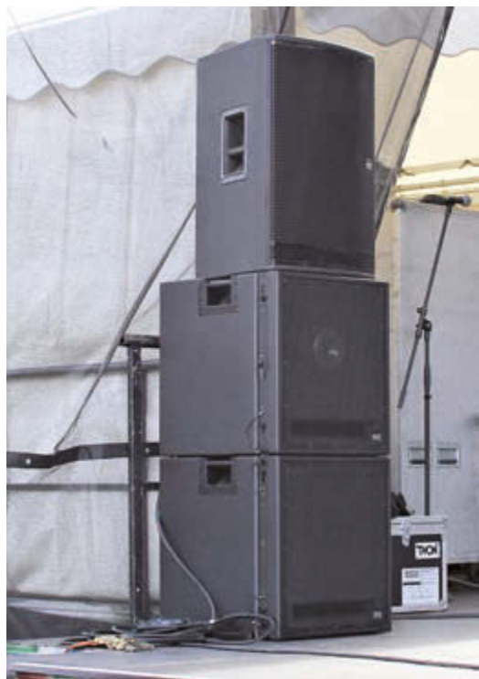
Bild 6: Pro Seite wurde ein Sidefill aus je zwei al-4SB Subwoofern und einem h-15N Fullrange-Modul auf der Bühne verbaut
