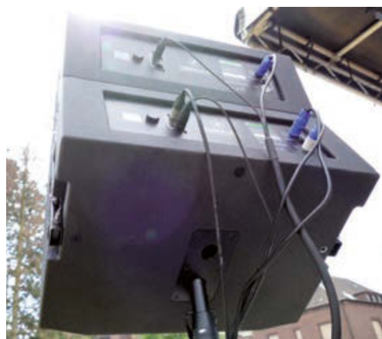
In den DRM12A Topteilen wurden, anders als beim Sub, Neutrik PowerCON-Armaturen verbaut
