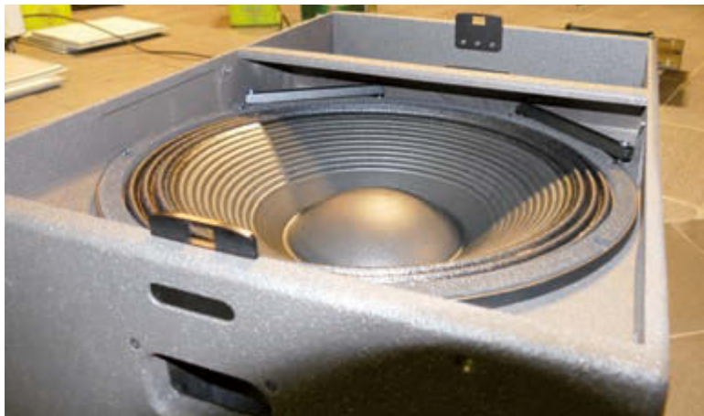
Der B&C 21 Zoll Treiber reicht bis unter den gebogenen Port – da dort kein Akkuschrauber hinreicht, wird der Tieftöner durch Metallschienen festgeklemmt
