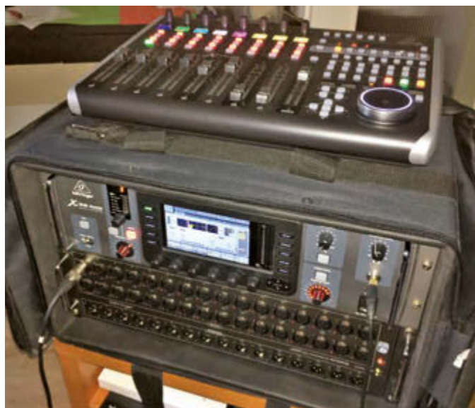
Den analogen Splittern folgte eine Behringer S32 Stagebox, die einen Digitalsplit ermöglicht – außerdem sorgt der Behringer X-Touch Controller für schnellen Zugriff auf alle Mix-Busse, wenn der WLAN-Zugriff nicht möglich ist oder instabil läuft
