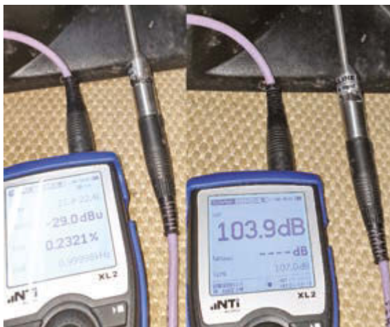
Bild 10: Das Messmikrofon iSEMcon EMX-7150 misst zusammen mit dem dazu passend kalibrierten NTi XL-2 Analyzer einen Schallpegel von knapp 104 Dezibel (SPL) – die Ausgangsspannung des Mikrofons beträgt dabei -29 dBu
