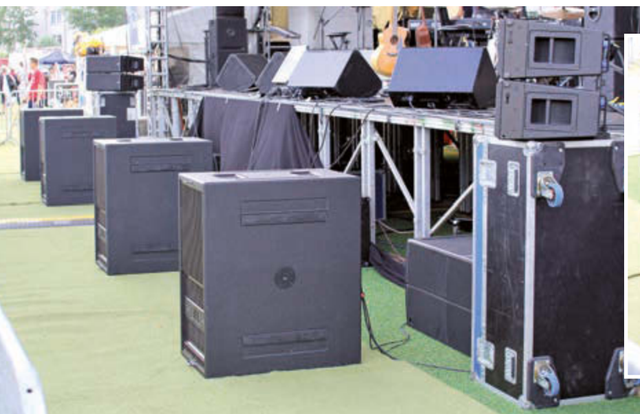
Bild 7: Die Bassabdeckung wird von vier al-12SB und vier hs-28 Bässen in Endfire-Anordnung vor der Bühnenfront übernommen
