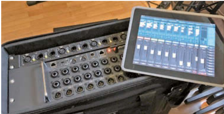
Die nächste Evolutionsstufe: Der XR18 bekommt gemeinsam mit den Splittern ein eigenes Rack – auch die IEM-Sender bekommen ein eigenes Rack (die Musiker können per App auf das XR18 zugreifen und sich ihren IEM-Mix selbst erstellen)
