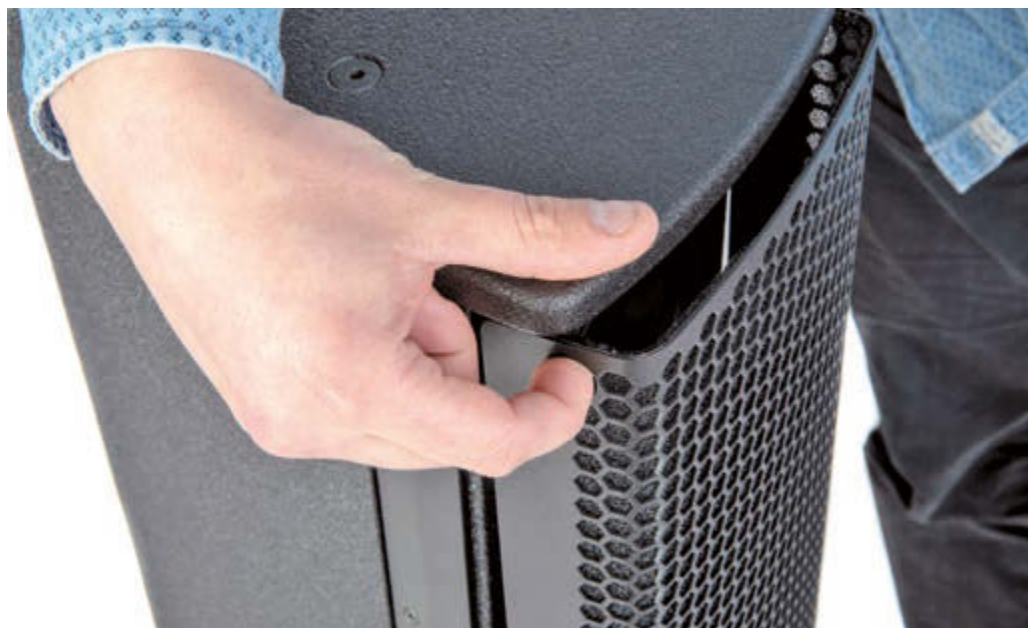
Das Wabengitter der VLX 5 lässt sich ohne Werkzeug abnehmen und der dahinter liegende 1 Zoll Wellenformer einfach drehen, um die Satelliten auch horizontal betreiben zu können
