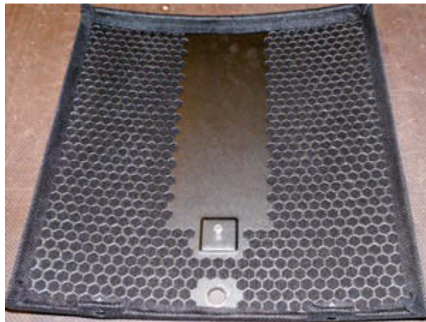
Der ungelochte Bereich soll den 15 Zoll PHL-Treiber in zwei akustische Zentren unterteilen
