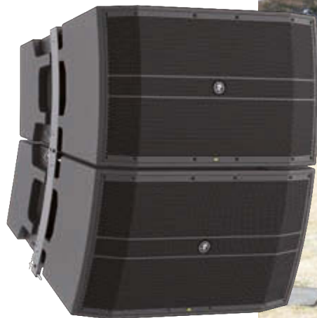
Bis zu zwei DRM12A Topteile können auf einer Distanzstange „aufsitzen“
