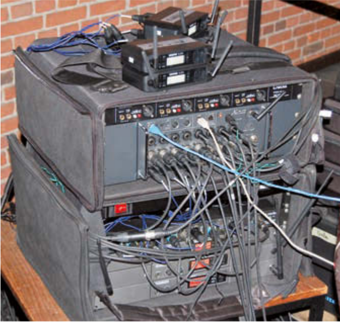
Das XR18 wurde durch ein X32 Rack ersetzt – weitere Splitter und eine 4-fach DI-Box ergänzen das System und legen damit auch Anschlüsse nach vorne
