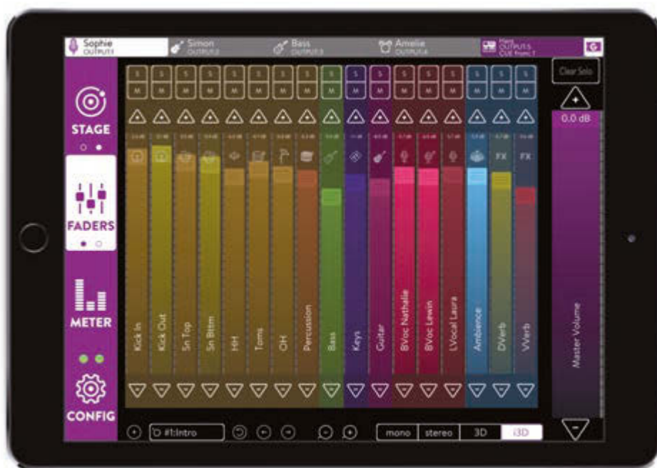
Zunächst lassen sich herkömmliche Mixe durchs Anpassen der Lautstärkeverhältnisse erstellen – der Clou ist aber, dass durch die Positionierung in der 3D-Umgebung der Fokus auf einzelne Instrumente gelegt werden kann, sie damit lauter wahrgenommen werden, ohne die Lautstärke anzuheben
