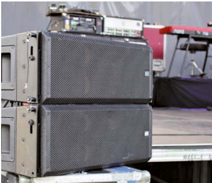
Bild 5: Frontfill-„Duos“ aus al-8 Line Arrays finden sich an den Bühnenseiten
