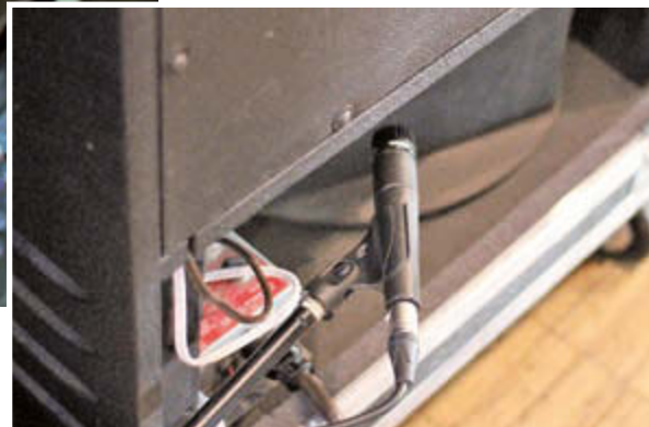
Bild 8: Untere Leslie-Abnahme per SM57, FoH-Mann Rob Hodgkinson: „Der Frequenzbereich muss beim Leslie nicht wirklich tief runtergehen, vielleicht bis 80 Hertz.“
