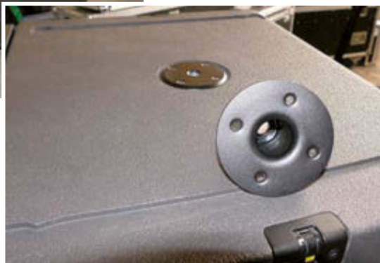
In den originalen L-Acoustics Hochständerflansch passt keine König & Meyer Distanzstange mit M20 Gewinde
