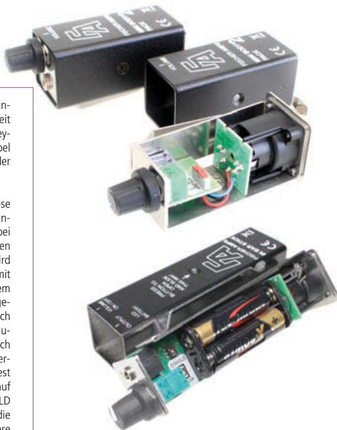
Fischer Amps In-ear Stick und Mini Body Pack 2: handliche Größe, geringes Gewicht – zwei AAA Batterien sorgen für die Spannungsversorgung beim In-ear Stick, zwei Mini Switches lassen die Wahl zwischen Mono/Stereo-Betrieb und Absenkung der Ausgangsleistung um 6 Dezibel (siehe Test in tools-Ausgabe 2/2017 – für Abo-Leser gratis verfügbar auf www.musicraft24.de )
