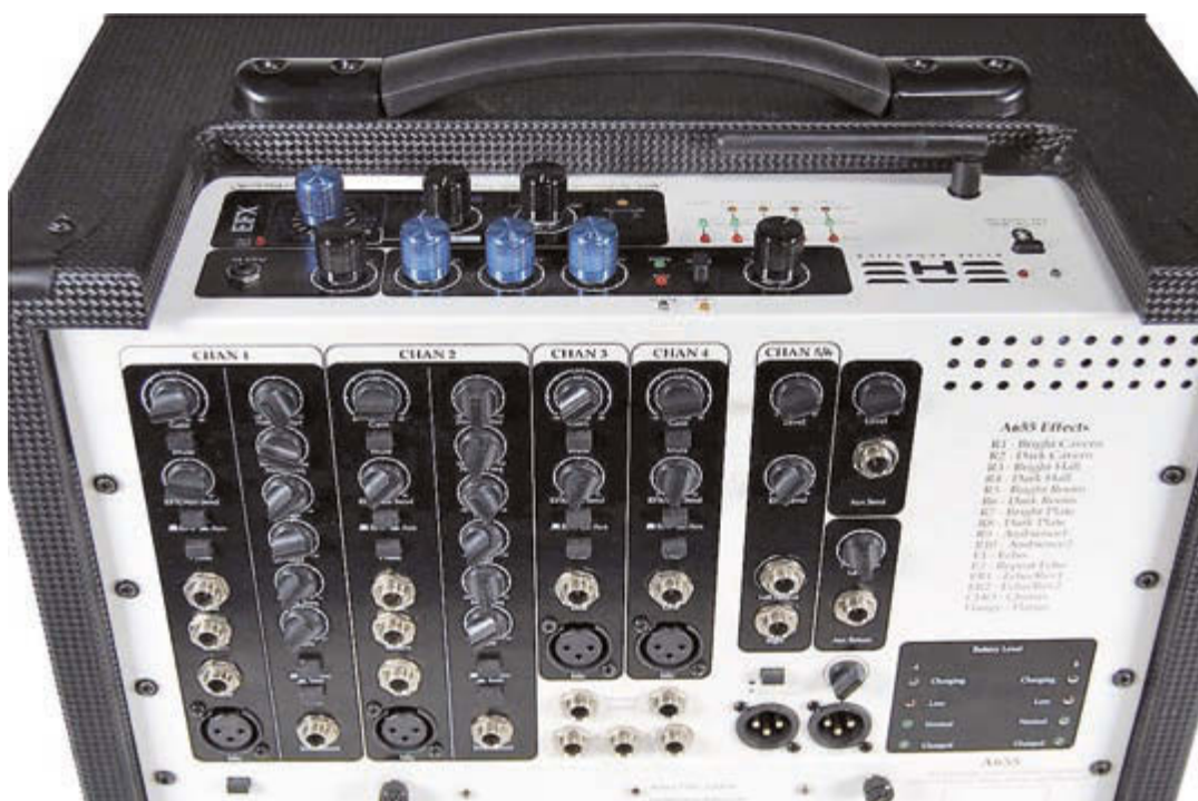
Auf der Rückseite beherbergt der EAE A6-55 ein gut ausgestattetes 6-Kanal-Mischpult mit vielen Anschlussmöglichkeiten
