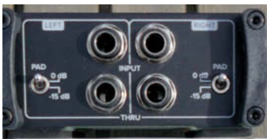
Für jeden Kanal der MDB-2P steht ein -15-Dezibel-PAD bereit
