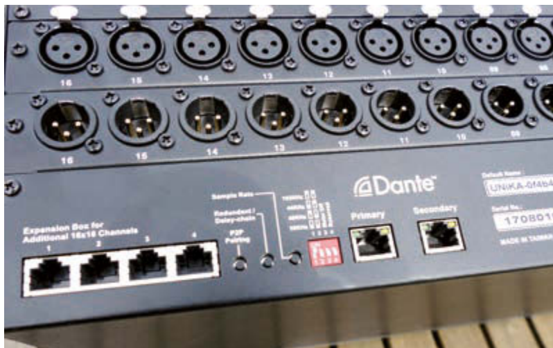
Über vier Netzwerkbuchsen kann ein NBB-1616 Expander andocken
