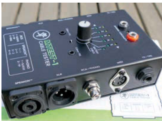
Der MTEST-1 kann alle wichtigen Audio-Verbindungen checken – praktisch wären RJ45-Netzwerk-Testbuchsen gewesen
