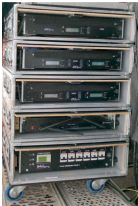
Zwei HDSP-6A Endstufen treiben sechs Ikaray-8 und acht Paveosub-118 an
