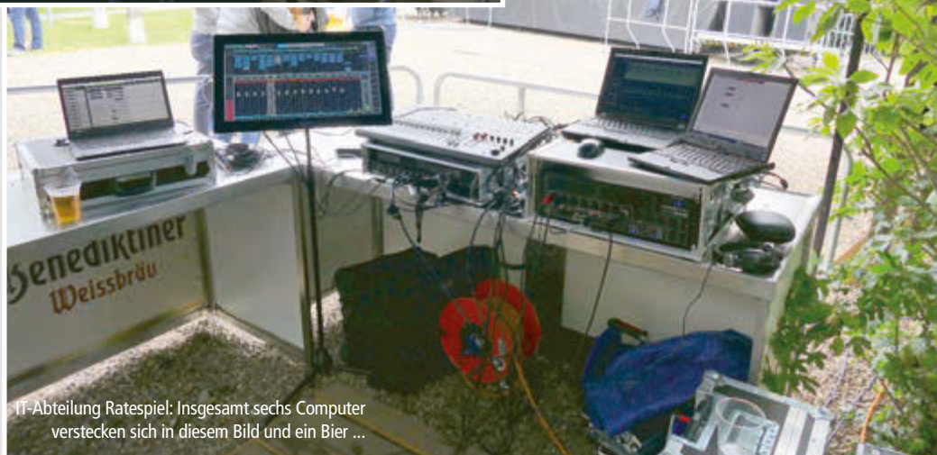
Dieses Rack beinhaltet den Host-Rechner, einen SoundGrid-kompatiblen Ethernet Switch und on top den Crest Audio Tactus Control
