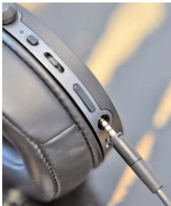
Das Kabel mit dem 2,5-Millimeter-Klinkenstecker lässt sich in der dafür vorgesehenen Buchse arretieren
