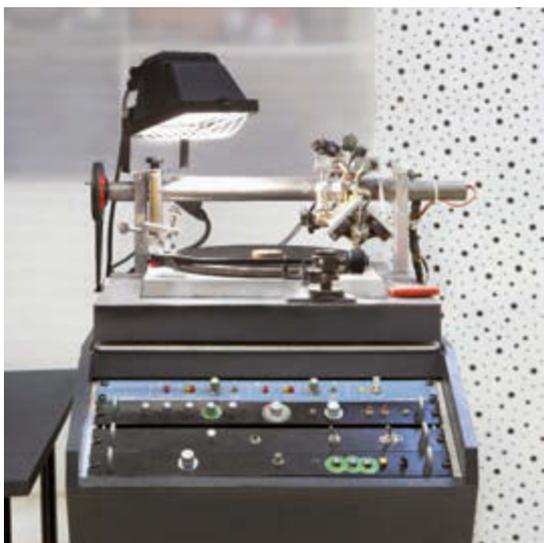
**Abb. 5:** Einer der beiden Schnittplätze für die härteren PVC-Rohlinge bei Einzelschnitten (Foto: Caro Dentler – permat-design.de)
