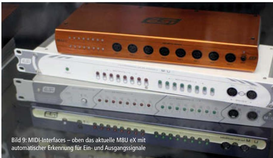
Bild 9: MIDI-Interfaces – oben das aktuelle M8U eX mit automatischer Erkennung für Ein- und Ausgangssignale
