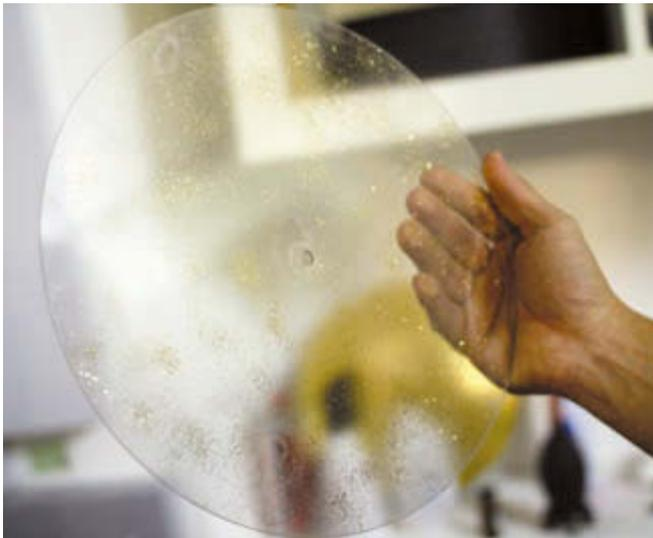
**Abb. 7:** Glitzer-Schallplatte als Einzelstück: Im Gegensatz zu einer „herkömmlichen“ Picture Disc, bei der die Rillen direkt in farbige Papierfolie geschnitten werden, was den Rauschabstand erhöht, befinden sich die Rillen hier im harten PVC
