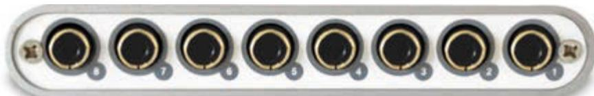
Bild 3: Auf dessen Rückseite sind acht Cinch-Ausgänge untergebracht. Riethmüller: „Das ist als kompakte Lösung besonders bei DJs beliebt.“ (Foto: ESI Audiotechnik)
