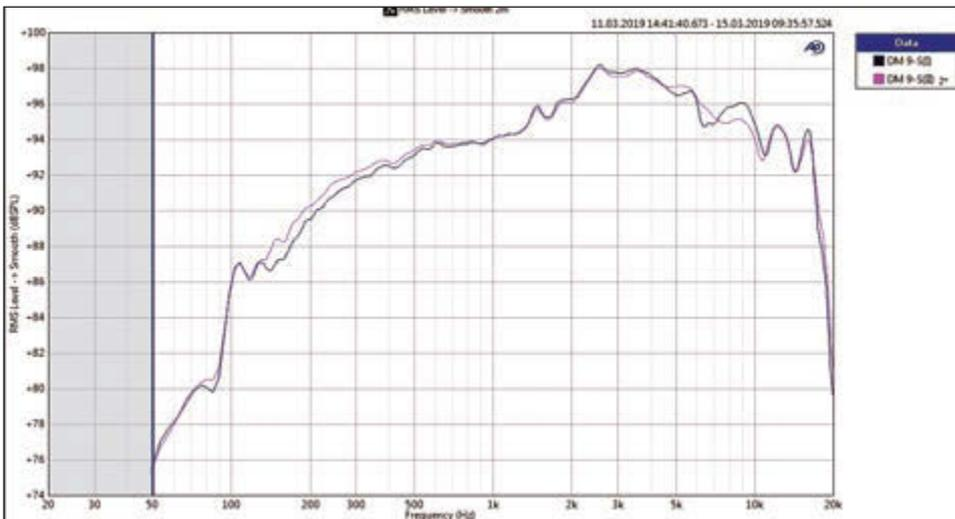
Paargleichheit/Fertigungstoleranz IMG Stageline DM-9S laut tools-Messung – die Vergleichsdarstellung der ermittelten Frequenzgänge von Mikrofon 1 (M1 bzw. I) und Mikrofon 2 (M2 bzw. II) zeigt eine Abweichung von 1 bis 1,5 Dezibel zwischen den beiden untersuchten Modellen – sichtbar wird auch die Erhöhung im Frequenzgang oberhalb von 1,5 Kilohertz
