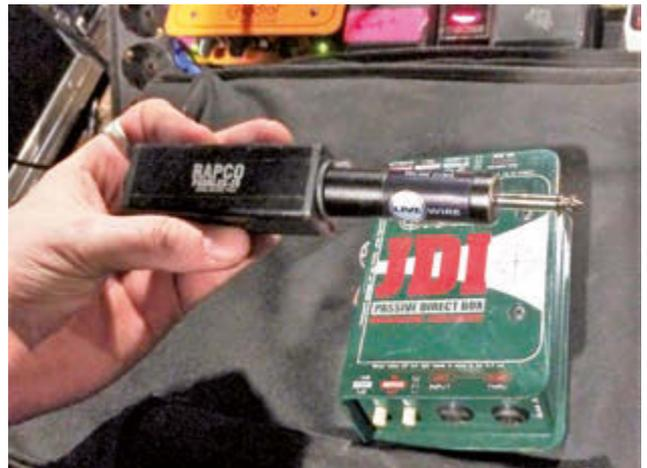
**Bild 8:** Als Ersatzlösung schleift Eggleston die Pedale über ein Rapco Paddbox-20 (-20 Dezibel) Inline Pad mit Livewire-Impedanzwandler und eine Radial JDI-Box ein: „Das Ergebnis klingt allerdings nicht ganz so gut, es findet mehr Kompression statt –, ich vermute, das liegt an der Impedanz“
