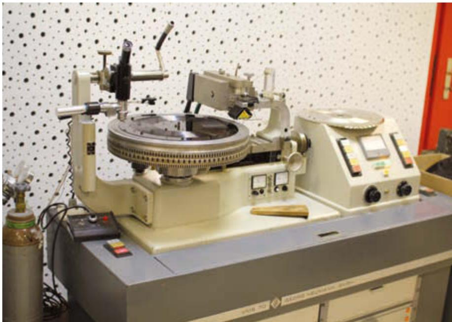
Abb. 3: Seine Schneidemaschine, eine Neumann VMS-70, hat Illner vor 14 Jahren gekauft, das Modell wurde zwischen 1974 und Anfang der 1980er Jahre gebaut
