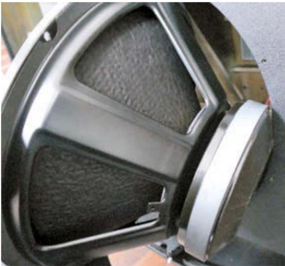
Der Ferrit-Treiber des DRM-18S Subwoofers arbeitet in einem Bassreflex-Gehäuse
