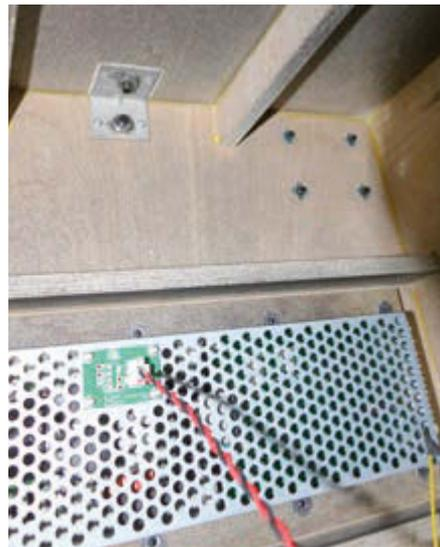
Der DRM 18S Subwoofer ist flugfähig, die Montagepunkte sind daher mit Metallwinkeln versehen
