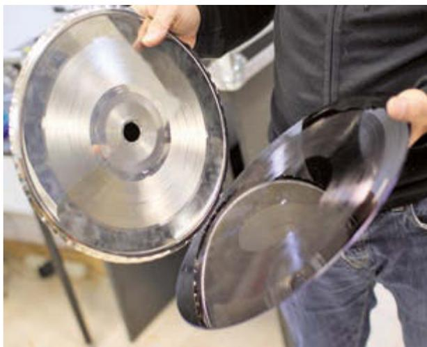
Abb. 4: Illner illustriert den Vorgang in der Galvanik des Presswerks, wo für die Vinyl-Pressung ein Nickel-Stamper vom geschnittenen Acetat gefertigt wird – das Trennverhalten von Stamper und Acetat bestimmt mit über Nebengeräusche der Pressung
