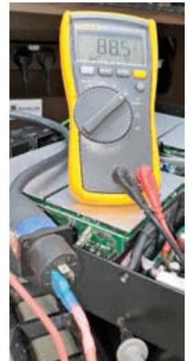
**Bild 3:** Allerdings führen sowohl Pin 1+ als auch Pin 1- vom Lautsprecher konstruktionsbedingt 88 Volt gegen Gehäuse beziehungsweise Schutzleiter – hier heißt es aufpassen
