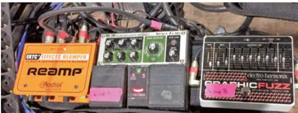
Bild 7: Für Gesangseffekte nutzt Eggleston unter anderem zwei Gitarren-Effektpedale, ein Boss Space Echo sowie ein Electro-Harmonix Graphic Fuzz – beide sind über einen Radial EXTC Effects Re-Amper ins Mischpult eingebunden (über den Radial wird die Impedanz angepasst, zudem kann Eggleston die Effekte damit schalten)
