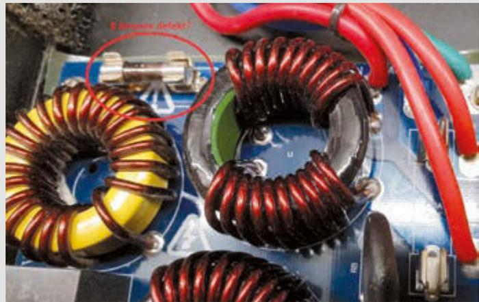
**Bild 11:** Wenn die rot markierte Sicherung defekt ist, liegt ein kapitaler Netzteilsschaden vor, ein bloßer Tausch der Sicherung hilft ... nicht weiter
