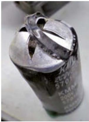
**Bild 13:** Das geschieht, wenn die Ausgangsspannung aufgrund eines Fehlers im Regelkreis des Netzteils die Spannungsfestigkeit der Kondensatoren übersteigt – der Kondensator platzt wie ein Tischfeuerwerk
