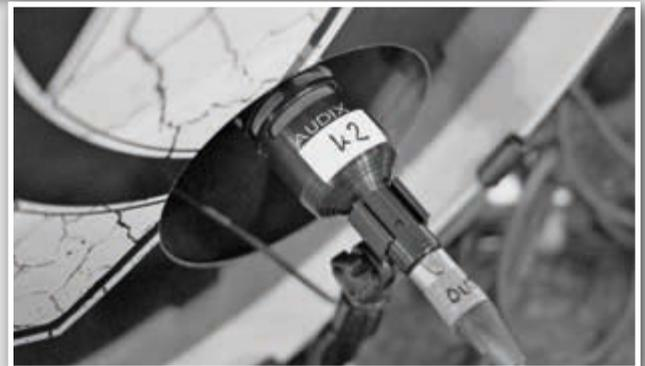
Abb.6: Beide Bass Drums sind außen mit je einem Audix D6 mikrofoniert sowie innen mit einer Shure Beta-91A-Grenzfläche – letztere dient den Attack-Anteilen. Bastian Emig: „Bei 24-Zoll-Bass-Drums ist die Trennschärfe zwischen Attack und Low-End-Schub zeitlich gegeben, weil eine Menge Luft bewegt wird, bei einer kleineren Bass Drum reicht es, gut zu dämpfen und ein Mikro weiter außen zur Gesamtabnahme zu nutzen.“
