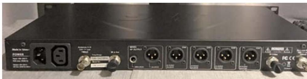
Auf der Rückseite finden sich die vier Receiver-Ausgänge im XLR-Format, die Mix-Ausgänge sowie die Antennenanschlüsse – eine Besonderheit ist, dass sowohl die Spannungsversorgung als auch die Antennensignale durchgeschleift werden können, so können sich bis zu zehn Receiver zwei Antennen teilen
