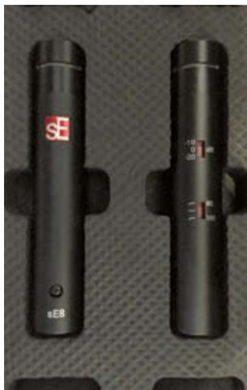
Das sE8 Mikrofon besitzt versenkte Schalter für die Dämpfung und das Low Cut Filter
