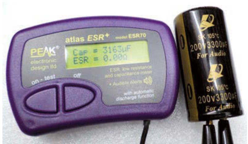
**Bild 14:** Der Test zeigt, dass die verwendeten Kondensatoren halten, was der Aufdruck verspricht –, nach Abzug der Toleranz liegen die Werte immer noch im „grünen Bereich“
