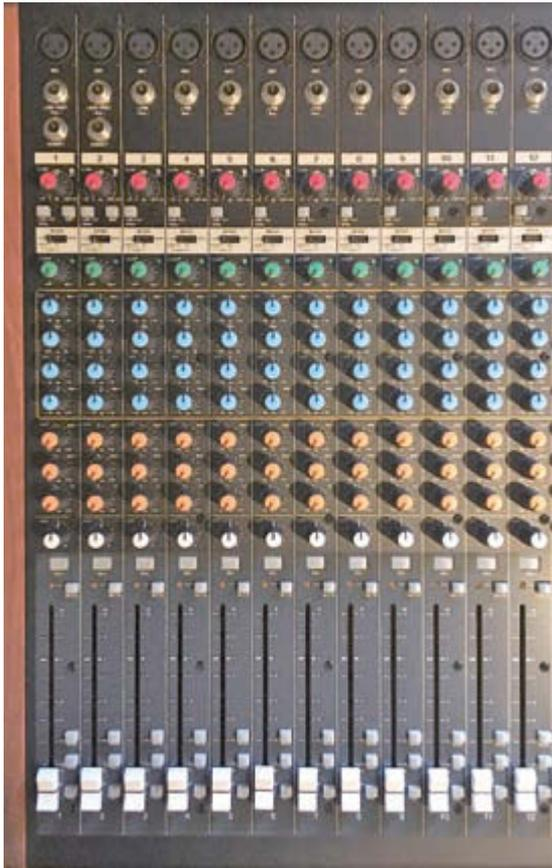
Alles drin, alles dran – den Benutzer erwartet ein typischer Kanalzug: Gain, One-Knob-Kompressor, Equalizer, Sends, Panorama, Fader
