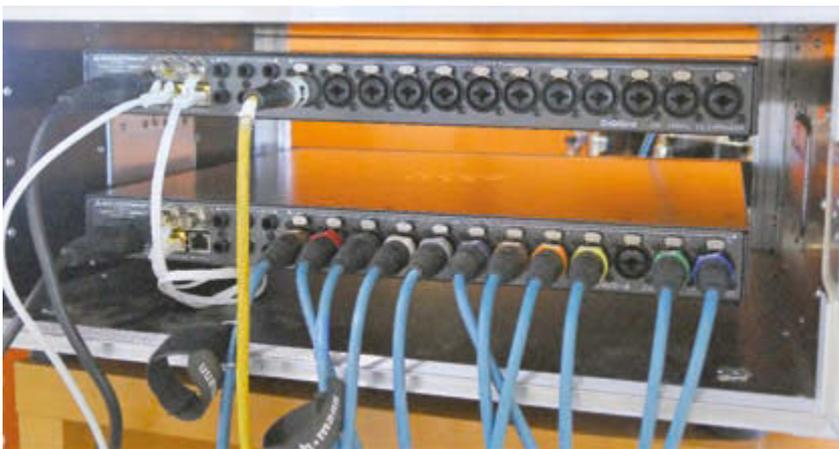
Jedes IOX-Modul weist 12 Mic/Line-Eingänge und sechs symmetrische Line-Ausgänge auf der Rückseite auf
