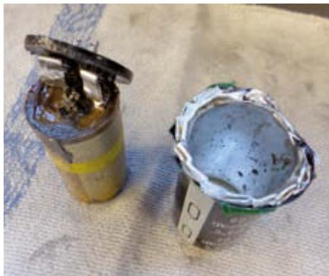
**Bild 15 A und B:** Der zerlegte Kondensator erweist sich als funktionierendes Originalteil
