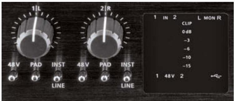
Getrennt schaltbar sind die 48-Volt-Phantomspannung, die PAD-Funktion sowie die Line-/Instrument-Signalanpassung – zudem steht pro Kanal eine mehrstufige LED-Pegelanzeige zur Verfügung
