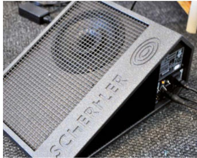
Der Teddy ist dank des Koaxiallautsprechers sehr flach konstruiert und bietet neben EQ-Sektion und Ground Lift Button einen Sensitivity-Regler und einen XLR-Ausgang, um weitere aktive Monitore kaskadieren zu können
