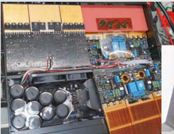
**Bild 6:** Der Hersteller dieser Baureihe hat die Kühlflächen nach hinten verlängert, um dadurch eine höhere Belastbarkeit zu erreichen
