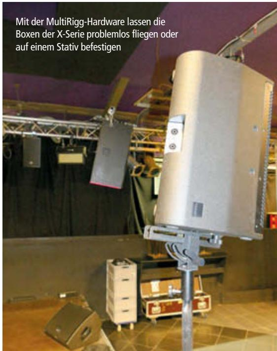
Mit der MultiRigg-Hardware lassen die Boxen der X-Serie problemlos fliegen oder auf einem Stativ befestigen
