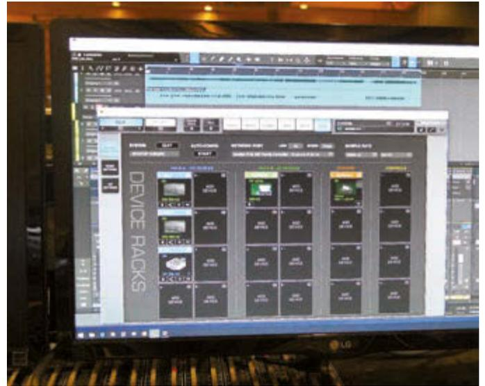
Im Setup-Menü des Waves LV1 Mixers wird die Hardware des Systems konfiguriert
