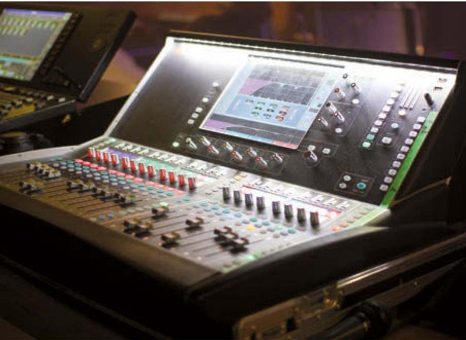
Abb.12: Allen & Heath dLive-Konsole, mit der Jan Saueressig sehr zufrieden ist – fast alle Effekte nutzt er in der Konsole, bis auf „Gesangsgitarrenverzerrung“ aus Native Instruments „Guitar Rig“ und das reFuse Subharmonizer-Plug-in „Lowender“, die er beide über sein Notebook einschleift
