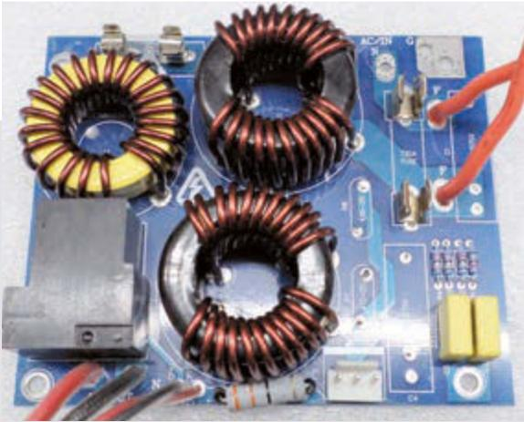
**Bild 8:** Das Netzfilter enthält neben den Filterdrosseln auch die Heißeleiter zur Einschaltstrombegrenzung sowie das Relais zur Überbrückung der Startschaltung
