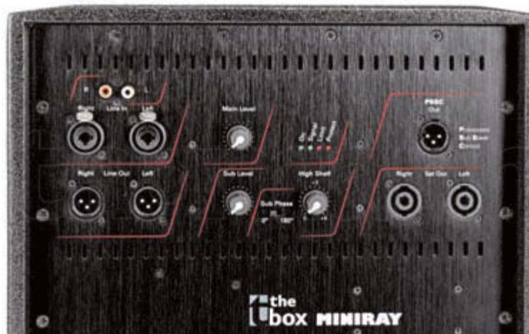
Die Satelliten-Module werden mit Speakon-Steckverbindern an den Sub angeschlossen – der zusätzliche DSP-gesteuerte PSSC-Ausgang ermöglicht die Verbindung mit einem weiteren Subwoofer
