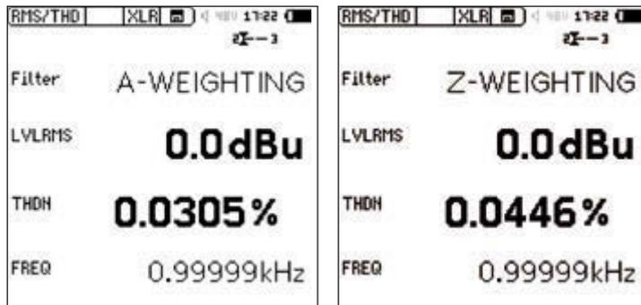
Messung der THD+N-Werte (A- und Z-Gewichtung) mit dem NTi-Audio XL-2 Audio-Analyser und dem MR-Pro Signal-Generator
