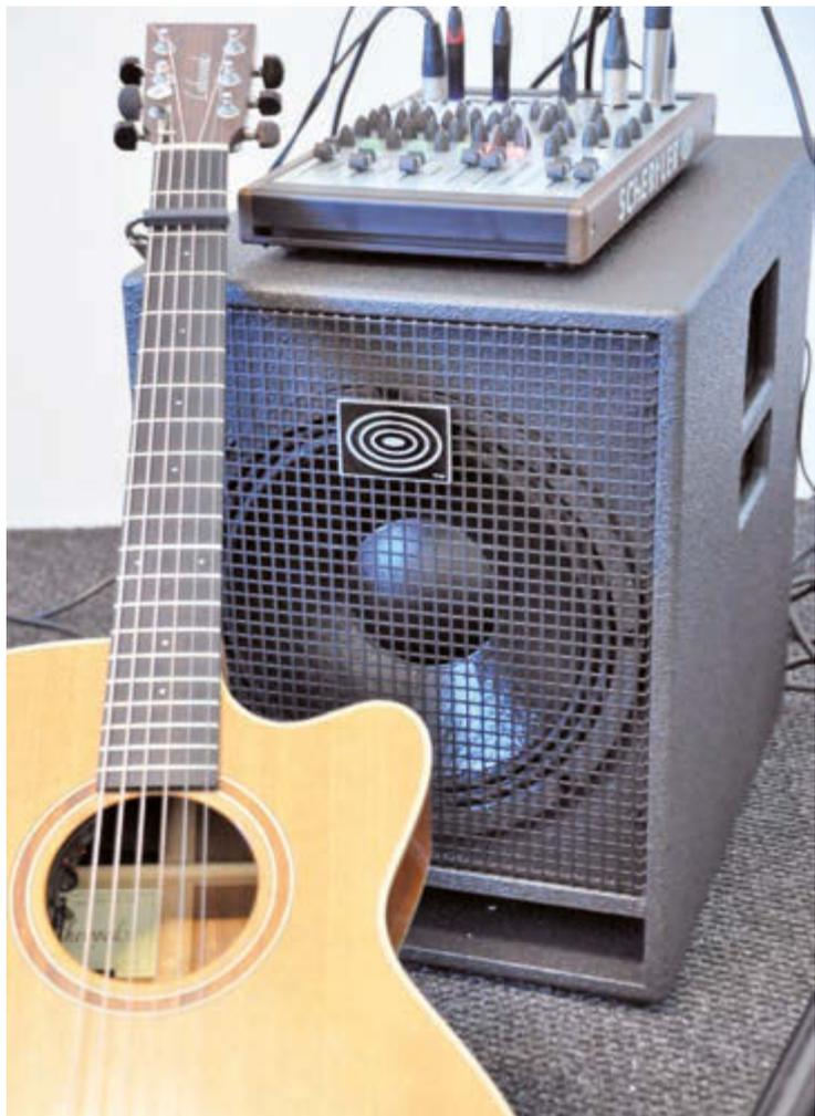
Der Sub ist als Bassreflex-Box (18-Millimeter-Spanplatte) mit einem 12-Zoll-Speaker inklusive Ferritmagnet bestückt – das Gewicht beträgt 24 Kilogramm
