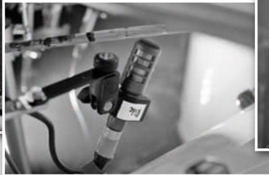
Abb.10: Ride-Stützmikrofon: Audio-Technica AE2300
