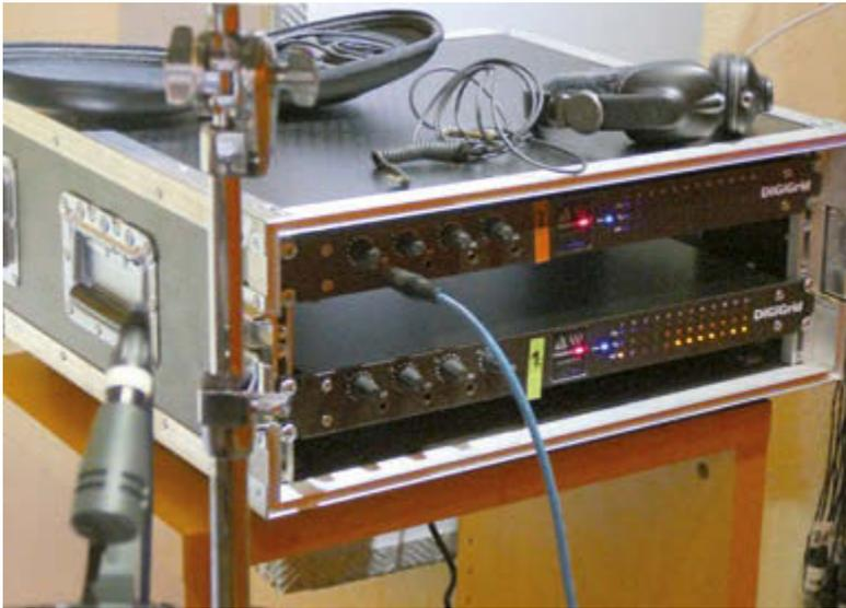
Jedes DiGiGrid IOX-Modul verfügt über vier separat adressierbare Kopfhörerverstärker
