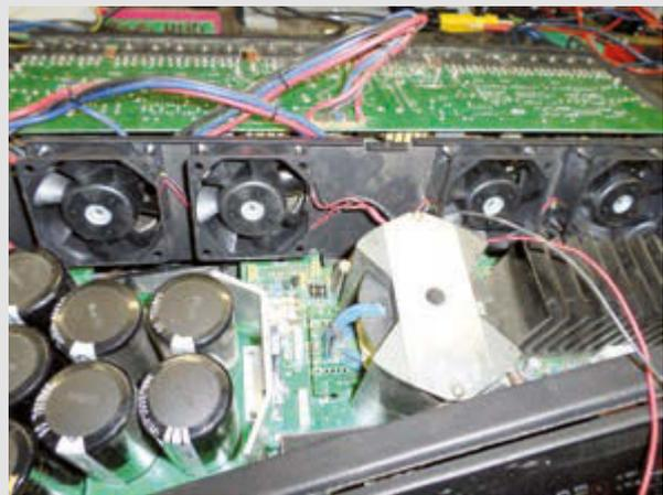
**Bild 5:** Ein Blick auf die Kühlventilatoren einer für Gisen Audio gefertigten 14.000er Version – bei diesen Modellvarianten sind die Ventilatoren in 48-Volt-Ausführung gefertigt, die meisten Wettbewerber nutzen 24-Volt-Lüfter in Reihenschaltung
