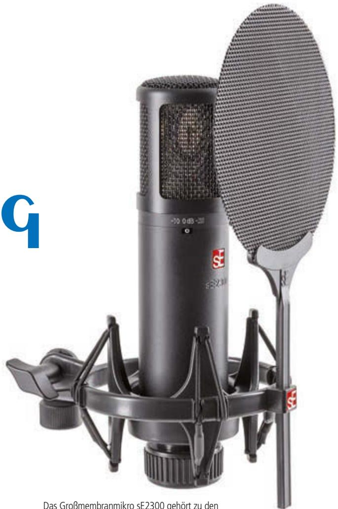
Das Großmembranmikro sE2300 gehört zu den imposanten Vertretern dieser Spezies – mitgeliefert wird eine Spinne und ein einfacher Pop-Schutz
