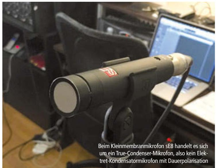
Beim Kleinmembranmikrofon sE8 handelt es sich um ein True-Condenser-Mikrofon, also kein Elektret-Kondensatormikrofon mit Dauerpolarisation
