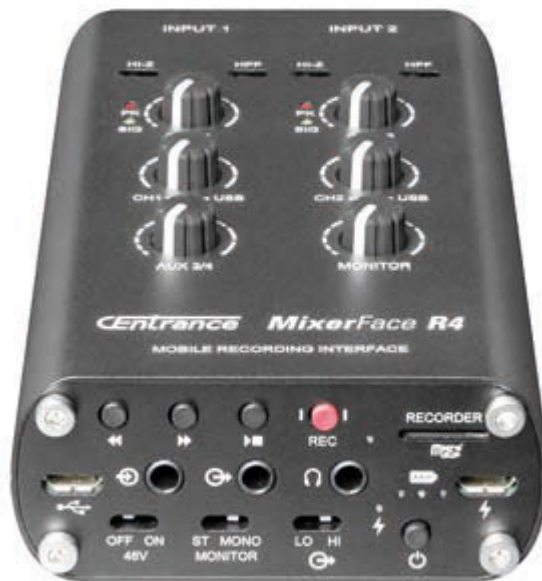
Dicht an dicht, weitere Anschlüsse sowie die Bedienelemente des SD-Recorders
