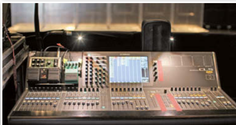
Abb. 5: Yamaha CL5 Pult, darauf links ein Roland RE20 Space Echo Effektpedal sowie ein Digitech Bass Synth Wah Envelope Filter: Das Space Echo nutzt FoH-Mann Markus Reisinger für Gesang, Sousafon oder bei Instrumentensoli, den Bass-Synthesizer mit dem Sousafon
