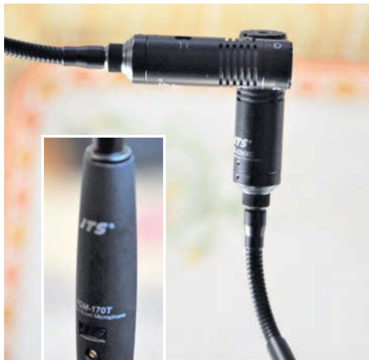
Die Overhead-X/Y-Anordnung (von unten gesehen) gelingt in etwa 2,80 Meter Höhe dank der flexiblen Schwanenhälse präzise, sicher und ohne Fixierungsprobleme
