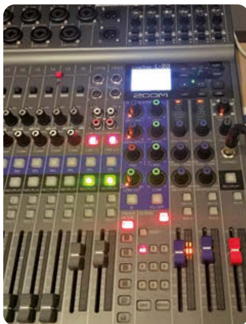
Die Anschlüsse für die beiden Stereokanäle liegen auf der Mischpultoberfläche, die Mastersektion enthält neben dem Recorder die Effektsektion und den Channel Strip für die Eingänge – auch die Szenenverwaltung und die Fader Modes sind hier zu finden
