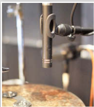
Abb. 7: Die „stationäre“ Abnahme erfolgt ebenfalls über MC930 Kondensatormikrofone, wie hier an der Hi-Hat, ...
