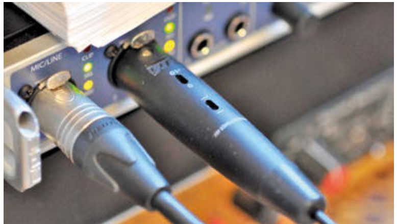
Praktisch: Beim FGM-170 finden sich die Schalter für Pad und Low Cut an der XLR-Buchse des Adapterkabels – das wäre eine wünschenswerte Option auch für das FGM-170T
