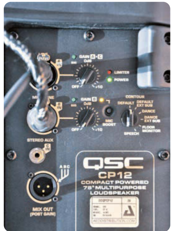
Die CP12 mit dem rückseitigen Bedienfeld: Die Box bietet einen Mikrofon-eingang (Kanal 2) und mit der zusätzlichen Mic-Boost-Funktion ist es kein Problem, dynamische Mikrofone ohne externes Mischpult zu verstärken
