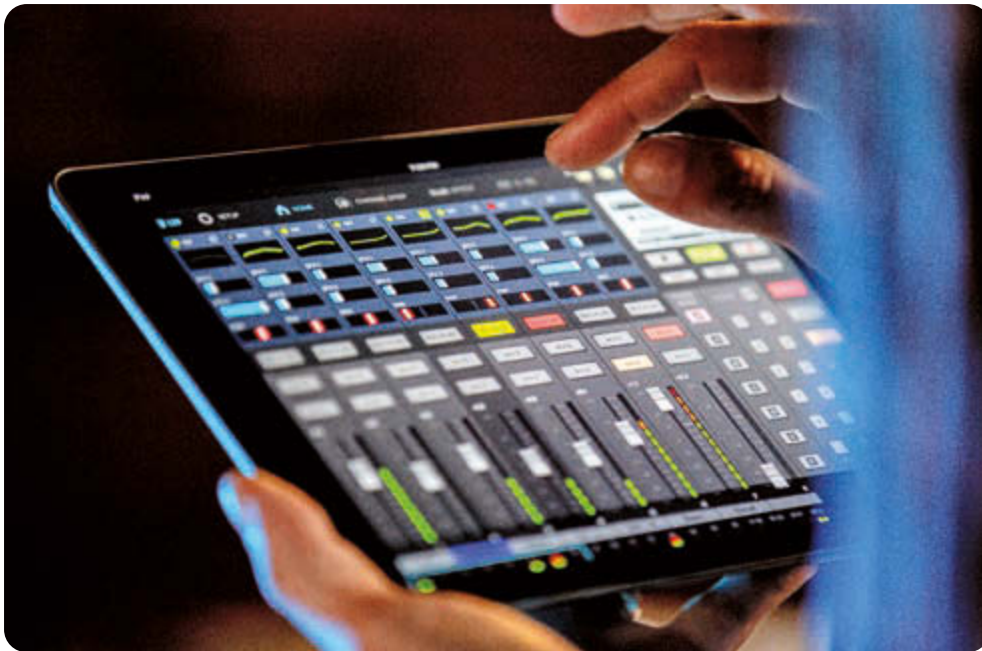
Per Bluetooth-Modul BTA-1 (optional) ist auch eine Steuerung per iPad App möglich – die App fügt dem Pult außerdem einen sonst nicht zugänglichen Terzband-EQ für den Master hinzu
