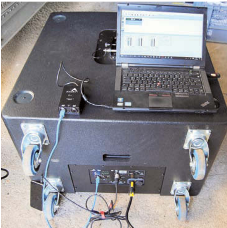
Aktive AXIOM Boxen verfügen über eine Netzwerk-Anbindung
