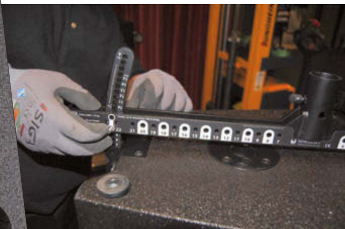
Mit dem multifunktionalen Flugbügel lässt sich das Top optimal ausrichten (links im Bild die Rückseite des Tops mit dem versenkt angebrachten Anschlussfeld)
