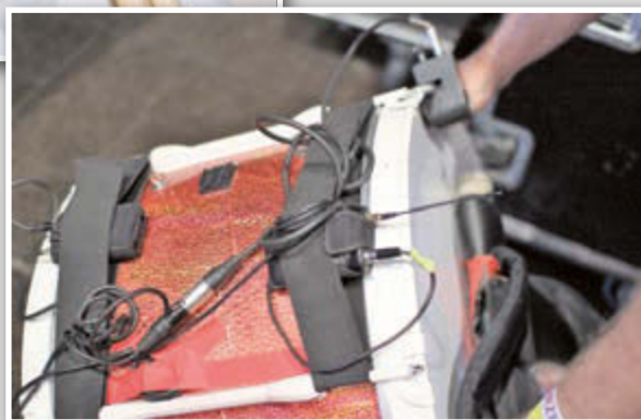
Abb. 11: Die Bass Drum wird mit einem dynamischen TG D70 und einem Trigger (rechts oben) abgenommen, der einen Controller auf der Bühne ansteuert – für die Signale sind zwei TG 1000 Sender an der Trommel befestigt
