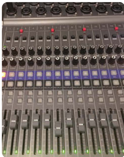
Die Eingangskanäle bestehen aus Gain-Regler, One-Knob-Kompressor, Select, Record/Play, Mute und Solo Buttons sowie einem Kanalfader – für die Eingänge 1 und 2 stehen HiZ, für die Eingänge 3 bis 16 PAD zur Verfügung.
