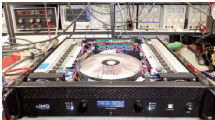
Bild 2: Bewährte Technologie – ein Ringkerntransformator mit 20 Zentimetern Durchmesser bestimmt die Gewichtsklasse
