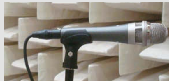
MM-80 mit abgeschraubtem oberem Korb
