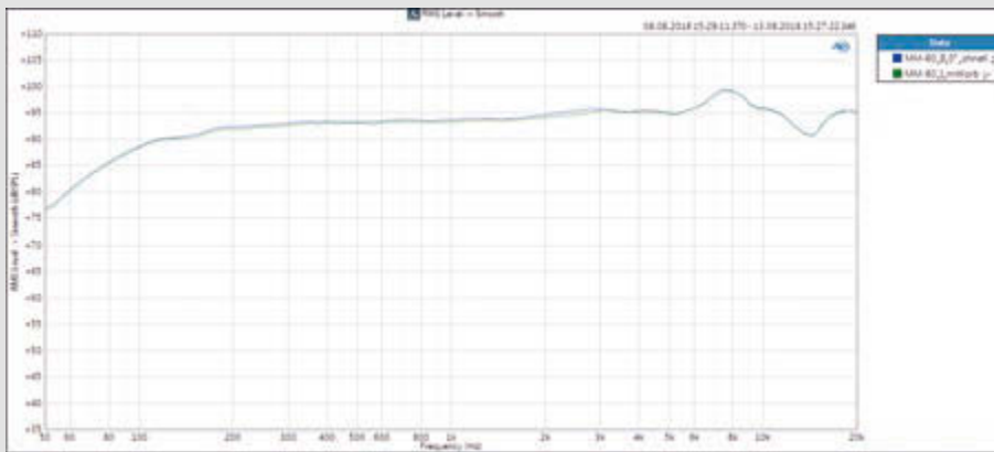
Geringe Auswirkung: MM-80 ohne und mit oberem Korb (0-Grad-Winkel und 1 Meter Abstand)
