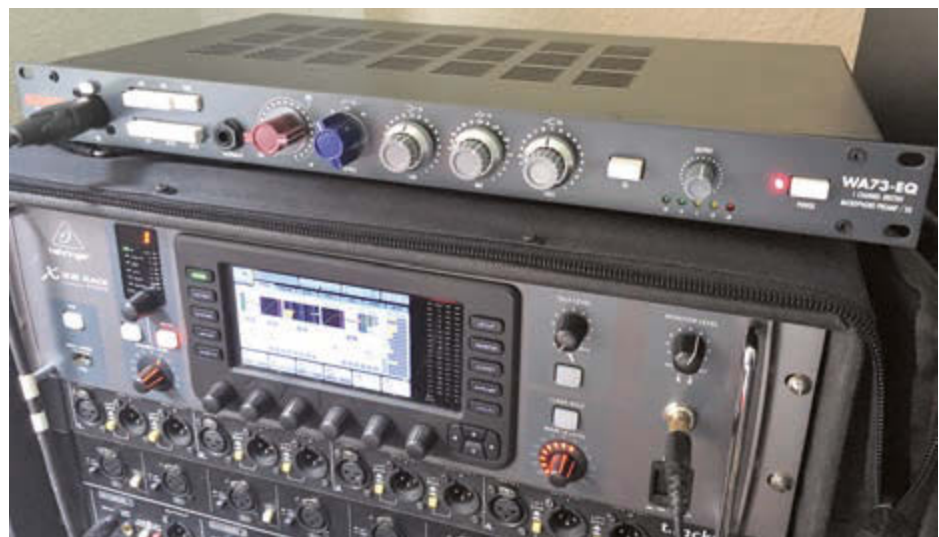
Beim Warm Audio WA73-EQ (oben) handelt es sich um einen Nachbau des Neve 1073 Preamps/EQs – bis auf zwei zusätzliche Höhenbänder hält sich die Kopie nahe am Original
