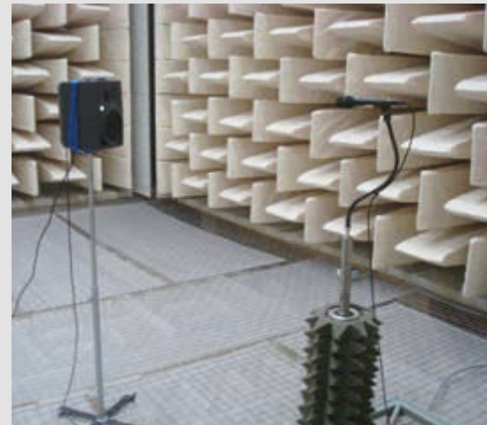
Mikrofonmessung: Drehroboter mit montiertem Mikrofon und Referenzschallquelle
