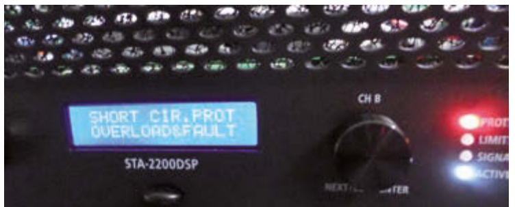
Bild 14: Nach dem Kurzschlussstest zeigt die Endstufe sowohl mit der Protect-LED als auch im Display den Störfall an
