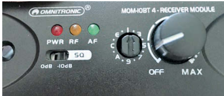
Die Kanalwahl am Receiver der Kanäle 1 bis 16 ist mit einem kleinen Schlitz-Schraubendreher möglich; die Beschriftung ist in dunkler Umgebung schlecht lesbar, ebenso die Position des kleinen Pfeils am Poti
