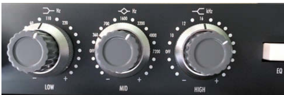
Die drei vom Neve 1073 bekannten klassischen Bänder werden im Höhenbereich um zwei weitere Frequenzen erweitert – der EQ lässt sich aus dem Signalweg nehmen, zudem verfügt jedes einzelne Band des Spulen-EQs über eine „Off-Position“
