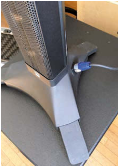
Ein schwerer Standfuß nimmt die Säulenelemente entweder direkt oder per zwischengeschaltetem Distanzrohr auf, alles per E-Connect: Der Standfuß selbst wird per Speakon-Kabel mit dem Subwoofer verbunden
