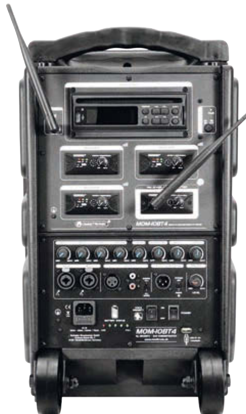
Das MOM-10BT4 ist ein modulares System – vier Erweiterungsschächte für Receiver oder das Audio-Link-Modul sowie ein Schacht für einen Media Player wollen mit optionalem Zubehör gefüllt werden, allerdings übernimmt der Vertrieb die erste Konfiguration vor der Auslieferung (weitere Module können vom Kunden nachbestellt und eingebaut werden)
