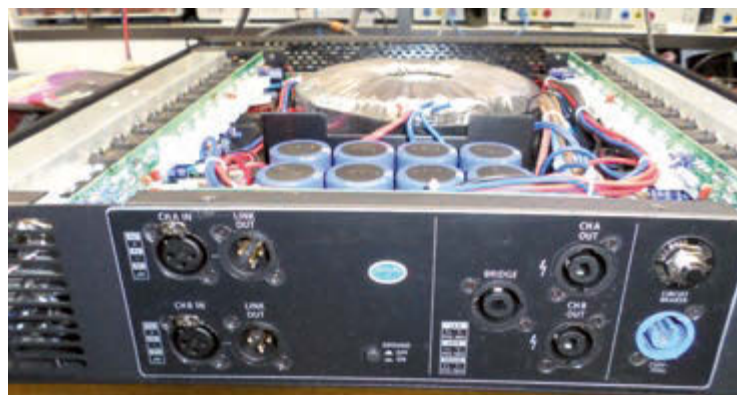
Bild 3: Die Rückseite weist alle benötigten Anschlüsselemente auf – ein 16 Ampere Sicherungsautomat schaltet im Störfall ab
