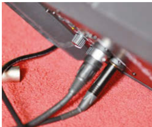
Bei der Bodenaufstellung haben lange 6,35-mm-Klinken recht wenig Platz und stehen unter Spannung, was auf Dauer zu Kabelbrüchen oder Beschädigungen der Eingangsbuchse führen kann – Abhilfe schaffen abgewinkelte Stecker
