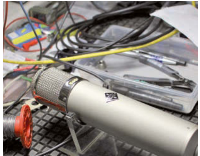
Bild 9: Vox-O-Rama U49 beim Zusammenbau: Mikrofon mit zweistufiger Röhrenschaltung
