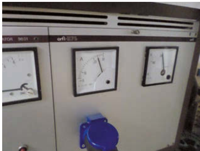
Bild 13: Bei kurzen Impulsen kann die Stromaufnahme durchaus bis zu 25 Ampere betragen
