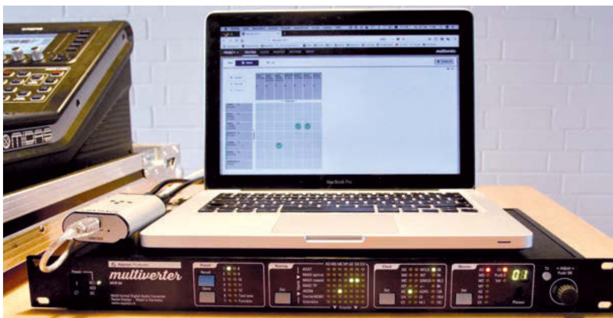
MVR-64 mit angeschlossenem DiGiCo UB MADI, AES50 per Midas M32R und Dante bzw. Steuerung per MacBook: vier Sektionen zur Bedienung des MVR-64
