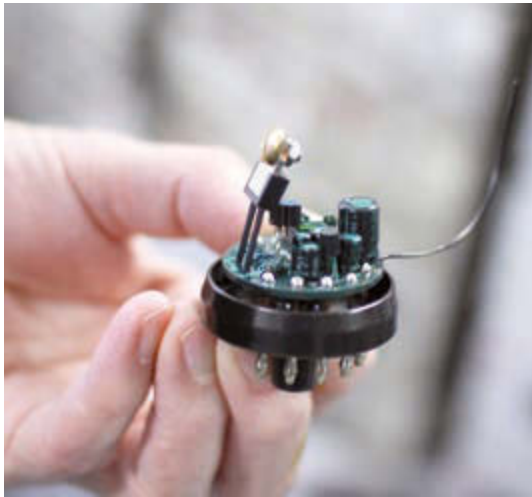
Bild 8: Blick unter die Stahlröhrenhülle: Aufbau der VF14 FET-Version
