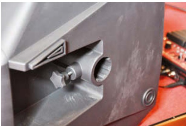
Der 35-mm-Flansch an der Unterseite dient zur Stativmontage (inklusive Arretierschraube)
