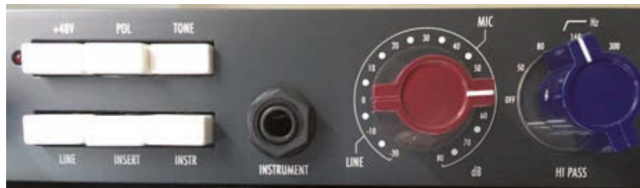
Die Preamp-Sektion verfügt über einen XLR-, einen Line- und einen Instrumenteneingang – sechs Buttons schalten die Phantomspeisung ein, ändern die Polarität, legen den Insert in den Signalweg, ändern die Eingangsimpedanz oder schalten den Instrumenten- oder Line-Eingang, das gestufte Gain Poti sowie ein High Pass Filter runden die Ausstattung ab
