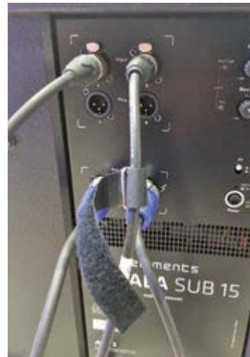
Das Anschlussfeld und die Bedienelemente befinden sich auf der Rückseite des Subwoofers (ein zweiter Subwoofer lässt sich einfach anschließen und damit das System für die Nutzung mit Bands erweitern)
