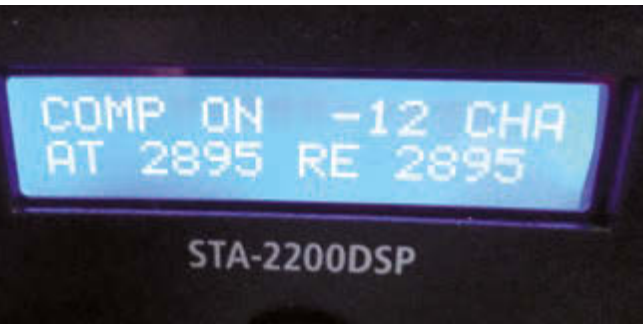
Bild 11: Die angezeigten Werte werden in der Bedienungsanleitung mit Millisekunden angegeben – hier beträgt die Reaktionszeit demnach 2.895 Millisekunden
