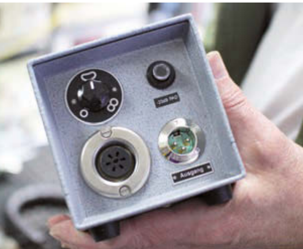
Bild 10: U49 Netzteil – die Kapselcharakteristik kann eingestellt und in den Übergängen „gemischt“ werden
