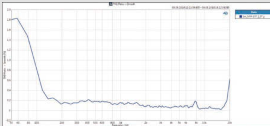
Der Gesamtklirrfaktor THD MIPRO MM-107 bei 0-Grad-Winkel im Abstand von 1 Meter liegt unter 1 Prozent
