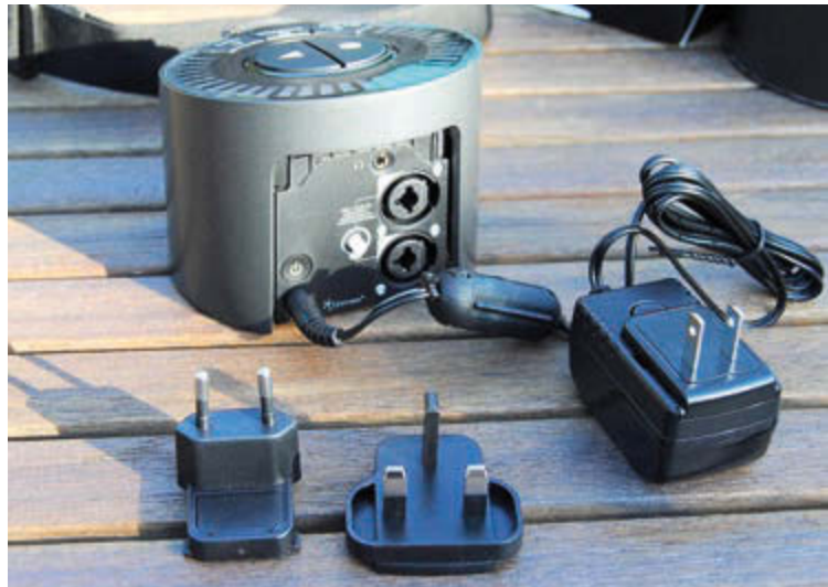
Das mitgelieferte Netzteil erweist sich durch verschiedene Adapter als Jet-Set-kompatibel
