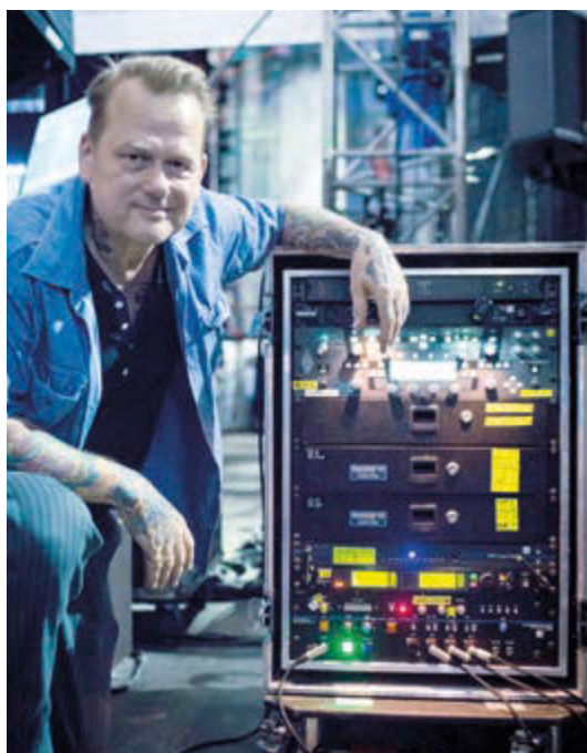
Das Main Rig besteht aus einem Kemper, drei Rack-Schubladen mit Bodentretern und zwei MIDI/Loopern aus dem Hause Skrydstrup
