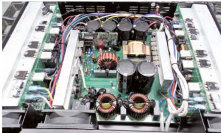
Bild 16: Die the t.amp TSA-1400 Endstufe hat drei Lüfter und ein sehr großes Schaltnetzteil in der Mitte – die links und rechts verbauten Endstufenblöcke können im Reparaturfall leicht ausgebaut und bei Bedarf repariert werden
