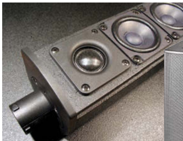
IMG Stageline C-RAY/8 (rechts): das obere von zwei Hochtön-Säulenelementen ohne Schutzgitter (oben; Test in Ausgabe 1/2015)
