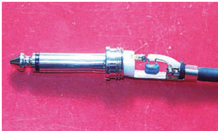
Kabel-Tuning: Der Kondensator – hier ein keramischer – wird zwischen Mittelleiter und Außenleiter des Steckers gelötet
