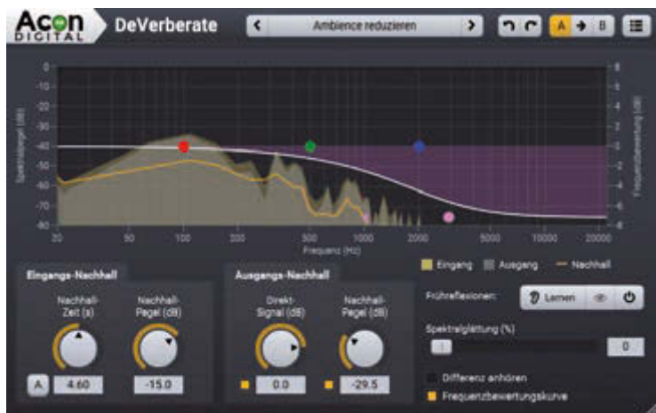
Abb. 1: Neues Design der Bedienoberfläche: Acon Digital „DeVerberate 2“
