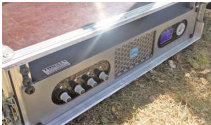
Die haus eigene System-Endstufe DA428 mit integriertem DSP
