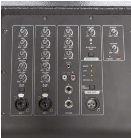
Das im aktiven Subwoofer integrierte Kleinmischpult
