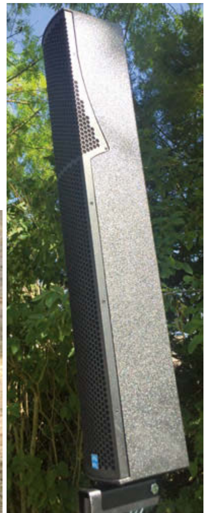
Die Säule in der Seitenansicht – sehr gut zu erkennen ist das gekrümmte Hochtön-Array
