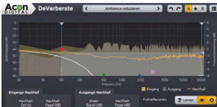
Abb. 3: Der erkannte Early-Reflection-Anteil lässt sich in der grafischen Oberfläche in Lautstärke und Frequenzbereich regeln
