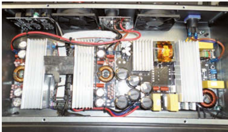
Bild 12: Die PSSO DDA-1700 hat ein Schaltnetzteil im rechten Teil und eine PWM Klasse D Endstufe links im Bild – der Aufbau ist sauber ausgeführt
