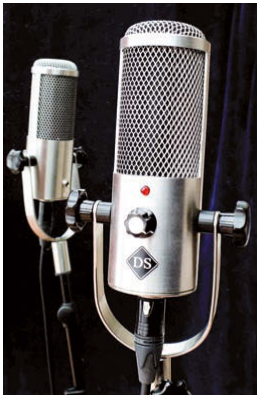
Abb. 4: Schöpfs Bändchenmikrofon mit komplettem eingebautem Preamp, um problemlos direkt auf einen Wandler zu gehen, alternativ bietet er eine Version mit „Pre-Preamp“ an, wie er sie für den Sender RBB geliefert hat (Foto: DS-audioservice)
