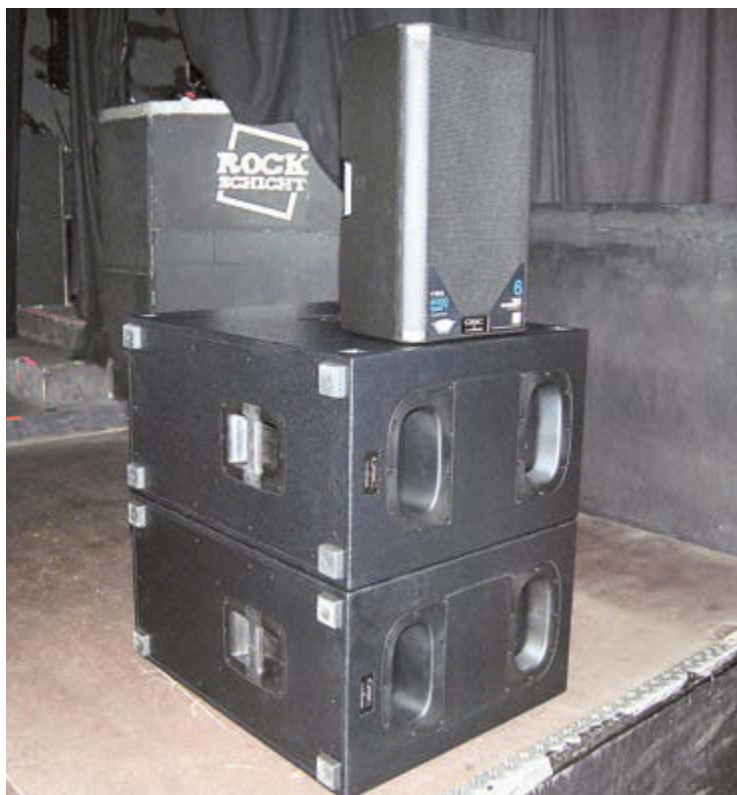
Durch die Stapelfräsungen rasten Bässe bei einer waagerechten Aufstellung sicher ein
