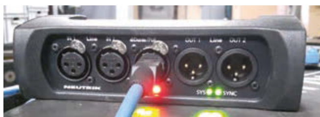
Bild 3: Neutrik NA2-IO-DLINE: Die Hardware ist betriebsbereit und signalisiert mit entsprechender LED-Anzeige die einwandfreie Konfiguration
