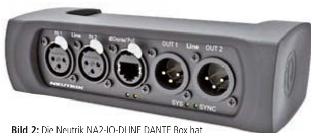
Bild 2: Die Neutrik NA2-IO-DLINE DANTE Box hat keinen separaten Netzteilanschluss – die Betriebsspannung erfolgt ausschließlich über die etherCON Buchse mit Power over Ethernet
