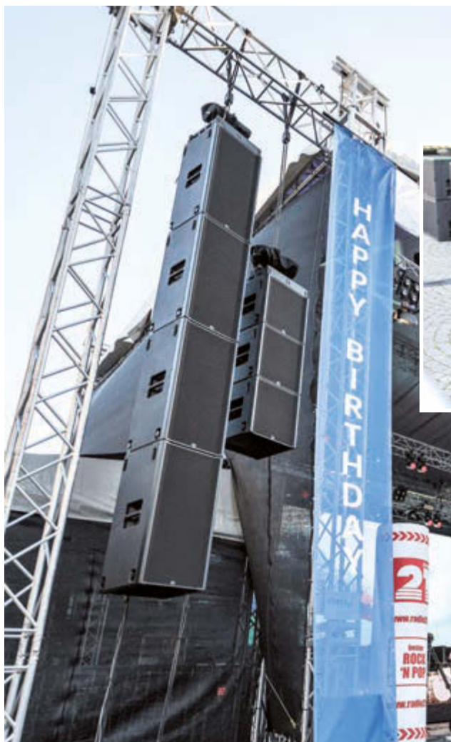
Bild 4: „Gestacktes“ Line-Array ohne Curving: Außen vier FV-200 Tief-Mitteltoner, aus Platzgründen wurden innen drei FV-100 Hochtoner gehängt – hinter dem Banner waren zusätzlich zwei XT4 Boxen als Nearfills positioniert (Foto: Fohhn Audio)
