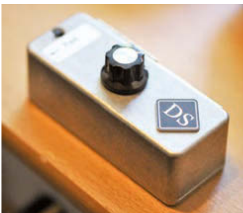
Abb. 5: Regelbarer „Pre-Preamp“ als externes Modell, um etwa Impulsverhalten und Verstärkung von dynamischen Mikrofonen zu optimieren: Schöpf zeigt sich vom Effekt bei spielsweise beim Shure SM57 begeistert
