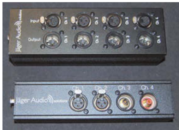
Beide Breakout-Boxen werden über Cat-Kabel verbunden – die untere Box verfügt sogar einen Übertrager für die Cinch-Eingänge
