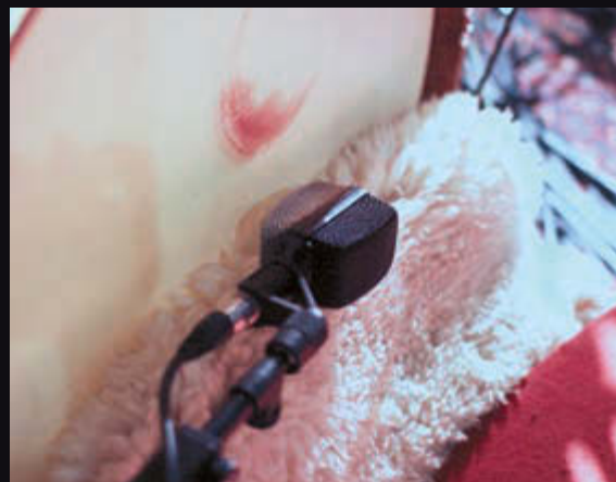
Bild 5: Die Bass Drum wird am geschlossenen Resonanzfell mit einem alten AKG D12 abgenommen
