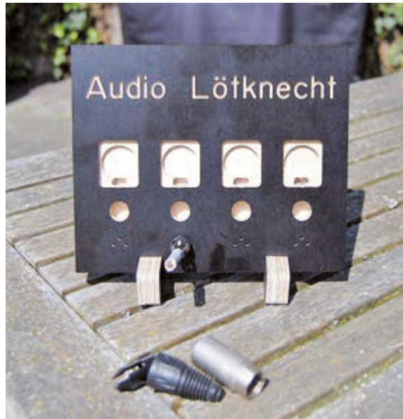
Der Lötknecht hilft beim Konfektionieren der bekanntesten Steckertypen
