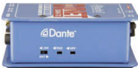
Bild 5: Mit den seitlichen Schiebeschaltern für Line- und Instrument-Umschaltung kann die Radial DiNET DAN-TX universell eingesetzt werden – die PAD-Funktion ermöglicht zusätzliche 18-Dezibel-Dämpfung; das Hochpassfilter hat eine Eckfrequenz von 80 Hertz; ein Ground-Lift-Schalter ist nicht vorgesehen
