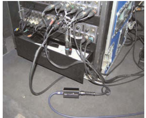
Das Cat Core erlaubt eine „geschlechtsneutrale“ Verkabelung
