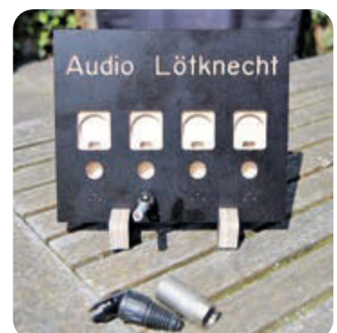
PRAKTISCH: DER LÖTKNECHT VON JÄGER-AUDIO- SOLUTIONS
