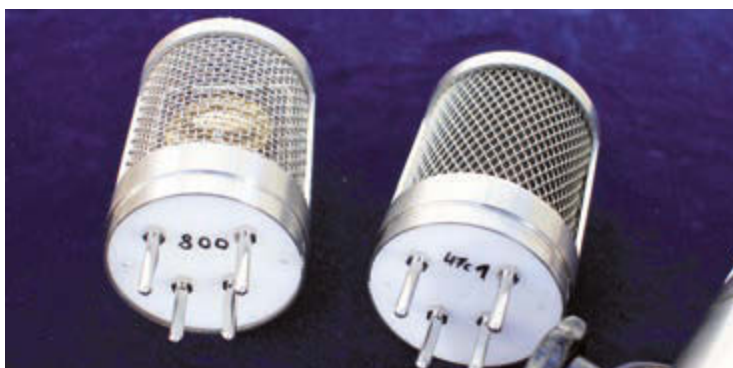
Abb. 8: Links Schöpfs Variante der Sony C800-Kapsel, daneben ein U47-Kapseltyp
