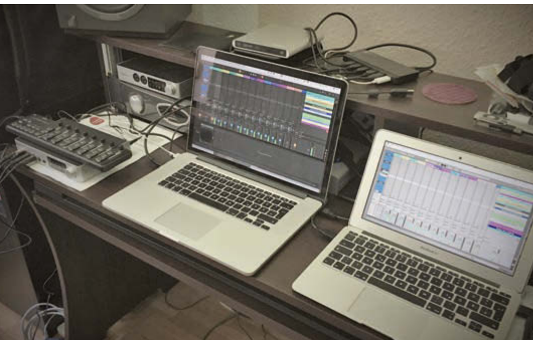
Das Test-Setup: Zwei MacBooks mit Ableton Live werden am PlayAudio12 betrieben – eine Korg NanoKontrol2 dient als gemeinsame Fernbedienung, um die Backing Tracks auf beiden Rechnern synchron zu starten; die Signalkontrolle erfolgte mittels Kopfhörer, um Knackser oder andere Schaltgeräusche besser identifizieren zu können
