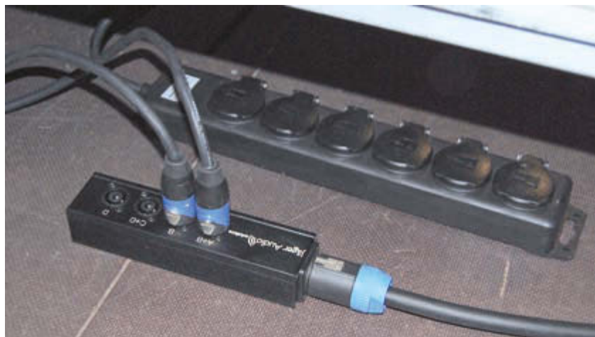
Die Breakoutbox stellt unabhängige Signale für vier Lautsprecherboxen/Monitore bereit
