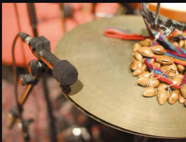
Bild 6: Ein Audio Technica ATM450 mit seitlich ausgerichteter Kapsel dient zur Hi-Hat-Abnahme – das abgelegte Percussion-Besteck befestigt Schlagzeuger Tommy Baldu als „Beinschellen“ am Unterschenkel, abgenommen von einem Shure SM57
