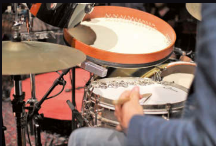
Bild 7: Sennheiser MD441 auf der Snare-Oberseite von Tommy Baldus „Trommel-Konglomerat“ – das Set ist „offen“ gestimmt, außer er verwendet Tücher, etwa auf der Snare oder Hi-Hat, als bewussten Dämpfungseffekt
