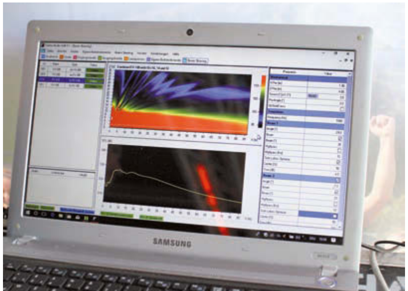
Bild 7: Fohhn Audio Software mit Beam-Steering-Funktionalität: Visualisierung des Abstrahlverhaltens und Einstellung des Neigungs- und Öffnungswinkels der Systeme in Echtzeit
