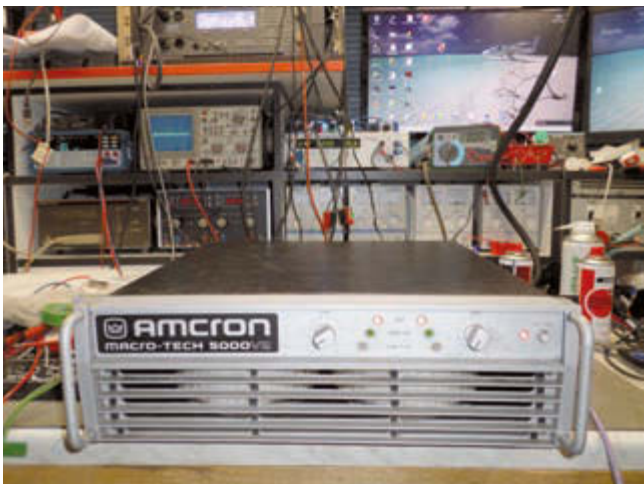
Bild 16: Die ehrwürdige Amcron 5000VZ ist wieder im Einsatz, beide ODEP LEDs sind aktiv und die IOC-Anzeige nicht aktiviert
