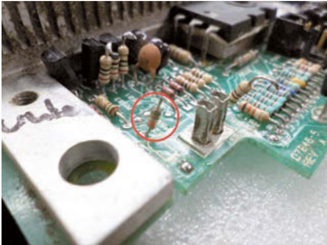
Bild 14: That's all – diese kleine Diode hat den Kanal 2 der Endstufe lahmgelegt
