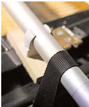
Abb. 4: Nicht-destruktiver Umbau: Die Stangen werden über Gurte an einem Flügel befestigt
