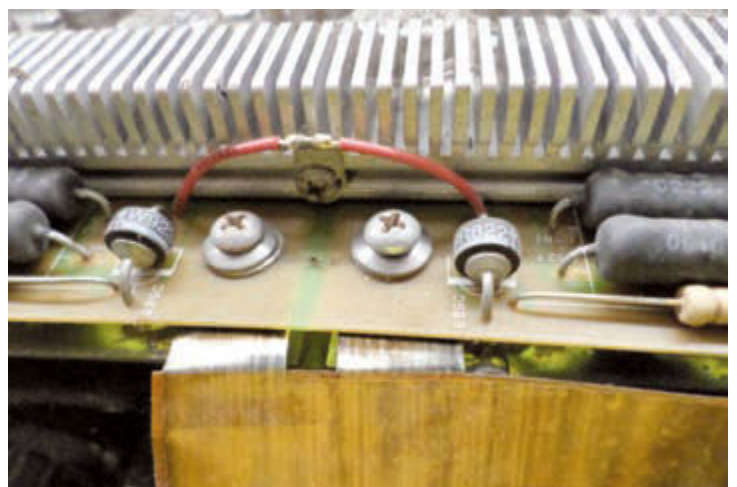
Bild 6: Diese beiden Schrauben sind Teil einer Klemmverbindung – sie kontaktieren gleichzeitig auch die obere mit der unteren Platine
