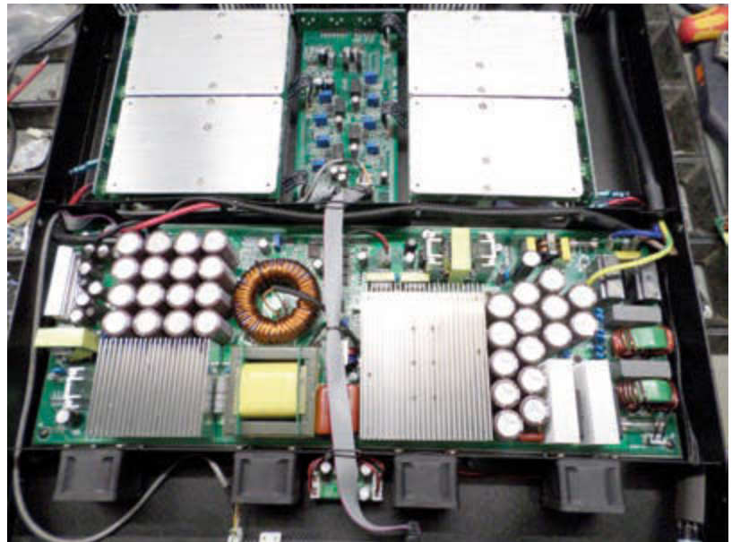
Bild 2: Innenansicht: vorne das Netzteil und im hinteren Bereich die Class-D-PWM-Endstufen sowie die Eingangsschaltung
