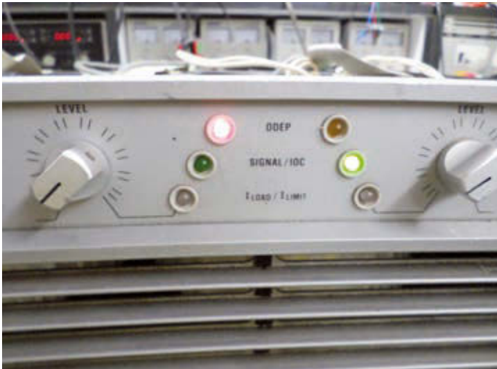
Bild 1: Die ODEP LEDs müssen beide leuchten – bei dieser Endstufe ist der rechte Kanal defekt (die IOC LEDs dürfen ohne Signal nicht leuchten)
