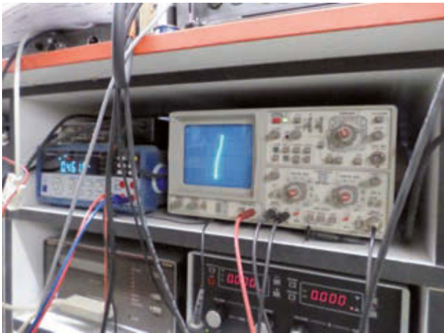
Bild 15: Das passt so nicht – normalerweise erscheint eine Diode als 90-Grad-Winkel auf dem Bildschirm
