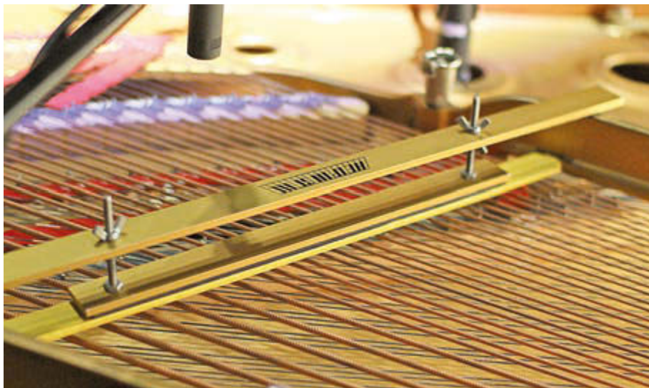
Abb. 10: Bassverstärkung: Einer von drei Tonabnehmern des amerikanischen Anbieters Helpinstill, die vor allem die Bassanteile des Flügels übertragen sollen
