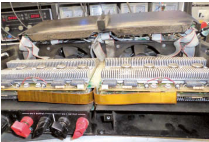
Bild 5: Die aufeinanderliegenden Teile der beiden Endstufenbrückenschaltungen sind mit einer doppelten Flachbandleitung mit den Lautsprecherklemmen verbunden
