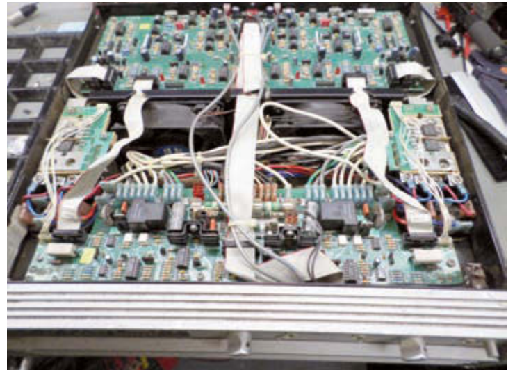
Bild 2: Nach Abnehmen des oberen Deckels zeigt sich die „intelligente“ Elektronik der Amcron 5000VZ Endstufe – vorne die Netzteilschaltung, im hinteren Teil die Vorstufen und Schutzschaltungen
