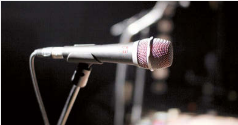
Abb.3: Als Background-Gesangsmikrofone dienen dynamische V7-Modelle von sE Electronics, deren Hypernieren-Charakteristik Monitormann Nickel Becker überzeugt, weil sie laute Monitor-Signale ermöglichen – zusätzlich werde das Übersprechen der jeweiligen Instrumente reduziert, ergänzt Lars Lüdemann.
