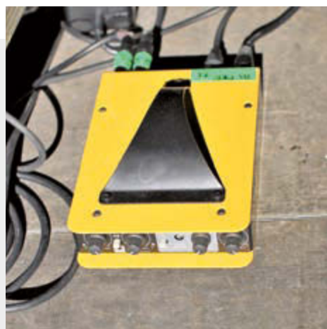
Abb.8: Bass-Abnahme: das „cleane“ E-Bass-Signal geht vor dem Effekt-Board über eine Radial Röhren-Di-Box ab – nach den Effekten folgt eine weitere DI-Abnahme über eine Radial J48
