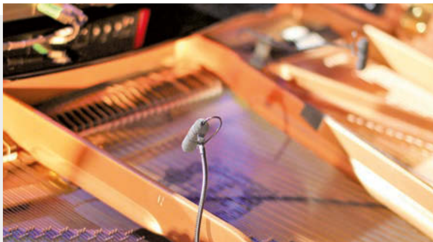
Bild 11: Flügel-Abnahme: Zwei DPA d:vote 4099 Kondensatormikrofone vom Club ...
