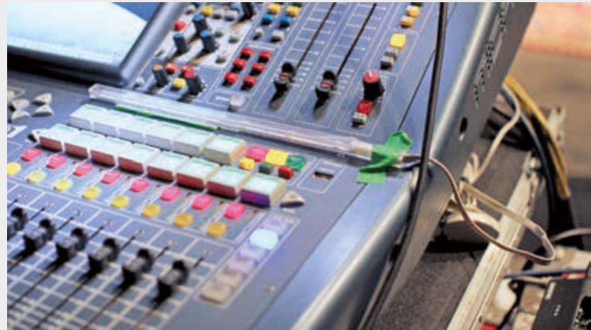
Abb.6: Die Produktion verwendet lediglich eine Funkstrecke: „Damit unser Backliner hinten im Off mithören kann und wir miteinander sprechen können“, erklärt Monitormann Nickel Becker; an seinem Midas Pro1 IP Monitorpult hat er dazu eine LED-Röhre angebracht (Nickel: „Aus der Not heraus geboren: Als Lichtsignal, wenn der Backliner mich rufen will, ich aber gerade die Wedges kontrolliere und sein Signal nicht höre.“)
