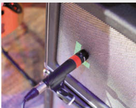
Bild 10: Zur Bass-Amp-Mikrofonierung setzt er lediglich ein Shure SM57 ein, das er im Bassbereich anhebt – für höher im Frequenzspektrum liegende Anteile dient ihm ein DI-Signal
