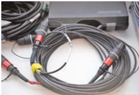
Glasfaserkabel – bei der stetig wachsenden Datenmenge in Audionetzen nicht wegzudenken
