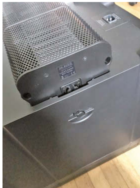
Bereit zum Transport – die beiden Satelliten sind zusammengesteckt in einer Transportmulde des Subwoofers – damit die Satelliten beim Transport nicht ungewollt auf „Wanderschaft“ gehen, besitzt der Subwoofer zwei Arretierungen an den Seiten
