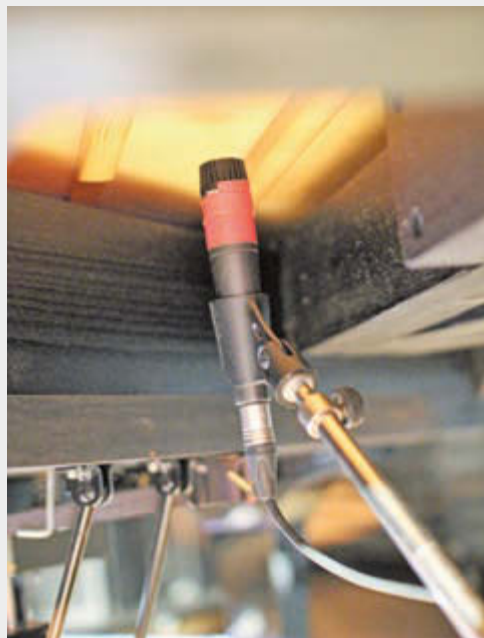
Bild 12: ... sowie unten ein SM57 – letzteres nur als Monitorsignal für die Wedges von Pianist Rafael Stepień und Schlagzeuger Irek Glyk, um als dynamisches Mikrofon die Feedback-Problematik zu entschärfen
