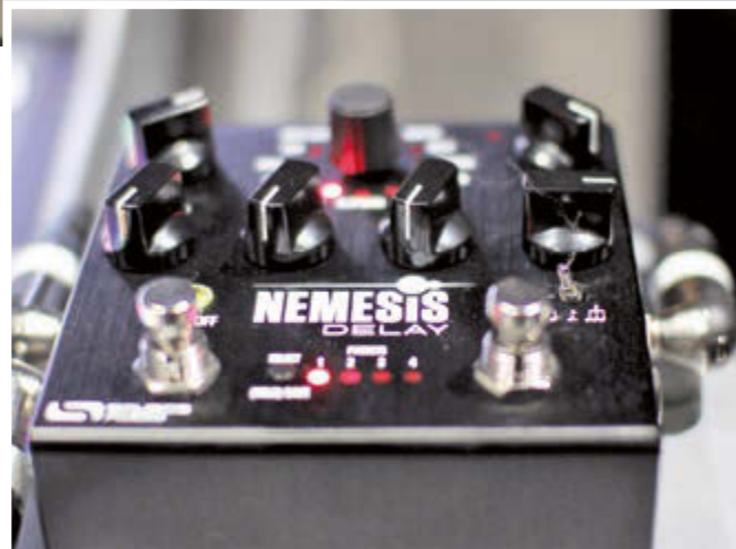
Abb.13: Einziger externer Effekt: Source Audio Nemesis, ein Gitarren-Delay-Pedal, eingesetzt für virtuelle Tape-Delay-Effekte und Hallräume mit kurzen Delay-Zeiten
