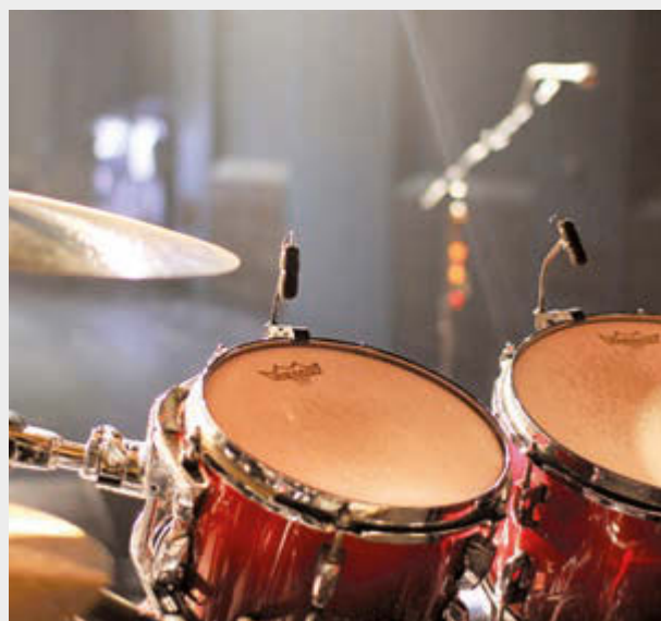
Abb.10: An den Toms: kompakte DPA d:vote 4099 Kondensator-Modelle: „Sie sind sehr offen, werden sie unter einem Becken platziert, wird zusätzlich viel Ride-Signal aufgenommen
