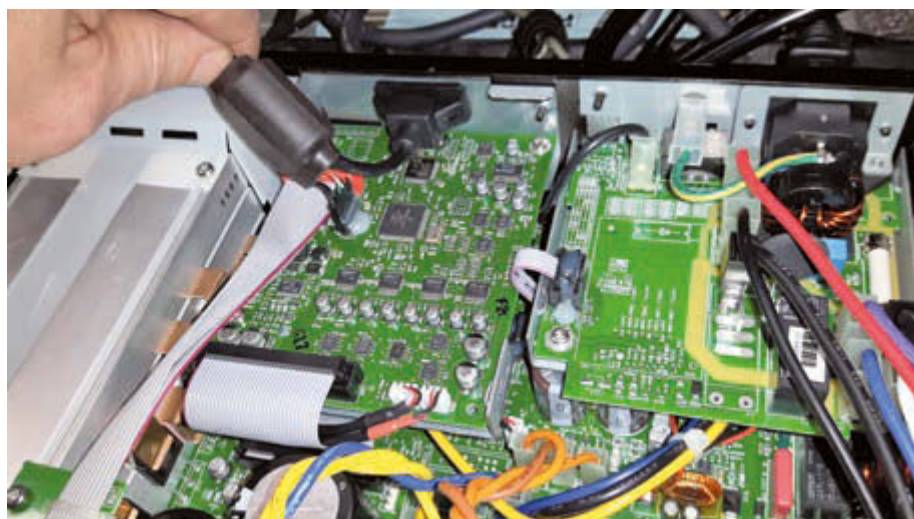
Bild 2: Die separate DSP-Platine ist mit hochwertigen Burr-Brown Wandlern und einem Symphony DSP56725 ausgestattet
