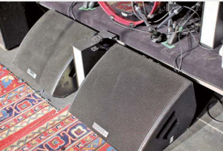
Abb.5: Die Produktion arbeitet beim Hauptgesang mit zwei Monitorpaaren – hier der doppelte „Gegenschuss“ vor dem Schlagzeug. Lüdemann: „Jan ‚badet‘ im Gesangs-Monitoring.“
