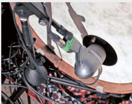
Bild 9: An der Bass Drum dient ein Shure Beta 52 für Tiefenanteile, dazu innen eine Beta 91A-Grenzfläche – für „funky Stuff“
