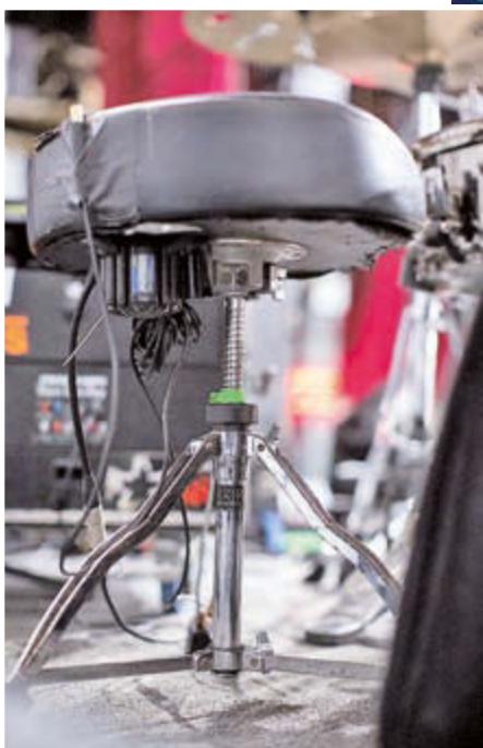
Drummer Max setzt zu seinem In-ear noch einen Bass Shaker ein, montiert am Drum Hocker unterhalb der Sitzfläche
