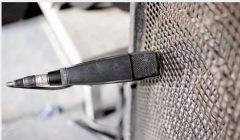
Abb.9: Die 4x15-Zoll-Box von Bassist Schmidths mikrofoniert er mit einem Sennheiser MD421 II, allerdings für Mittenanteile vorab gefiltert
