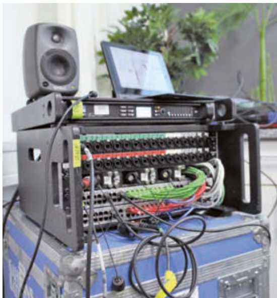
Ein fertig konfigurierter Switch für Audionetze
