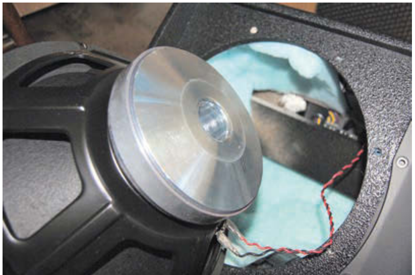
Der 12-Zoll-Ferrit-Treiber gehört zur Kategorie „einfaches Modell mit Blechkorb“
