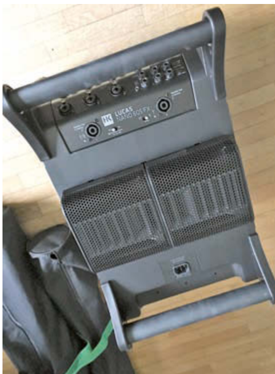
Bereit zum Transport – die beiden Satelliten sind zusammengesteckt in einer Transportmulde des Subwoofers – damit die Satelliten beim Transport nicht ungewollt auf „Wanderschaft“ gehen, besitzt der Subwoofer zwei Arretierungen an den Seiten
