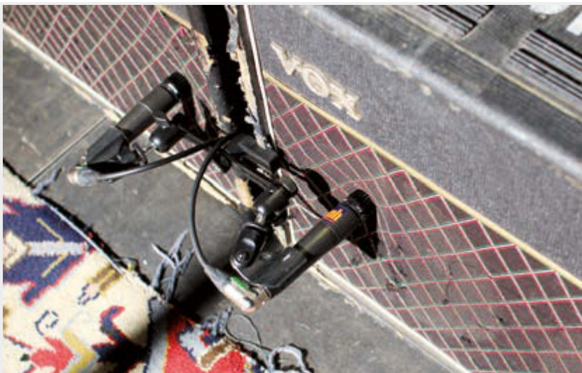
Abb.7: Die beiden alten Vox AC30 – links ein Combo, rechts ein „entkerntes“ Exemplar als Zusatzbox – sind mit je einem Shure SM57 mikrofoniert – Lüdemann mischt sich daraus seinen FoH-Gitarren-Sound. Lüdemann: „Christian nimmt bei der Show den ganzen Raum ein – es ist schon passiert, dass er versehentlich Mikros auf Stativen in die Kalotte getreten ist.“
