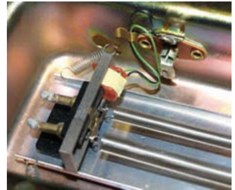
Abb. 1: Hallsystem mit zwei Federn ( http://www.accutronicsreverb.com ; http://fr.audiofancine.com )
