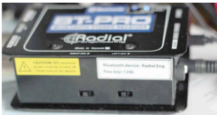
Beim Testmuster löste sich der weiße Papier-Aufkleber für den Bluetooth-Verbindungscode (rechts im Bild, Gehäusekante): Ein Gehäuseaufdruck wäre praxistauglicher
