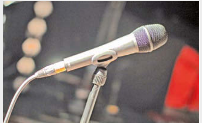
Abb.4: Für Sänger Jan Plewka verwendet Lüdemann ein DPA d:facto II Kondensator-Mikrofon mit Supernieren-Charakteristik: „Die Kapsel lässt sich bei Bedarf auf Adapterstücke von DPA schrauben, dann passt sie auf alle gängigen Funk-Bodys.“
